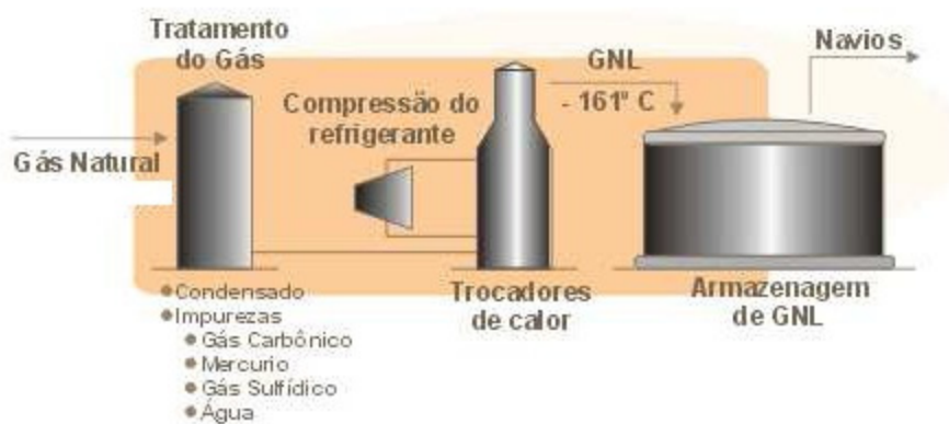
Figura 17: Unidade de liquefação.
