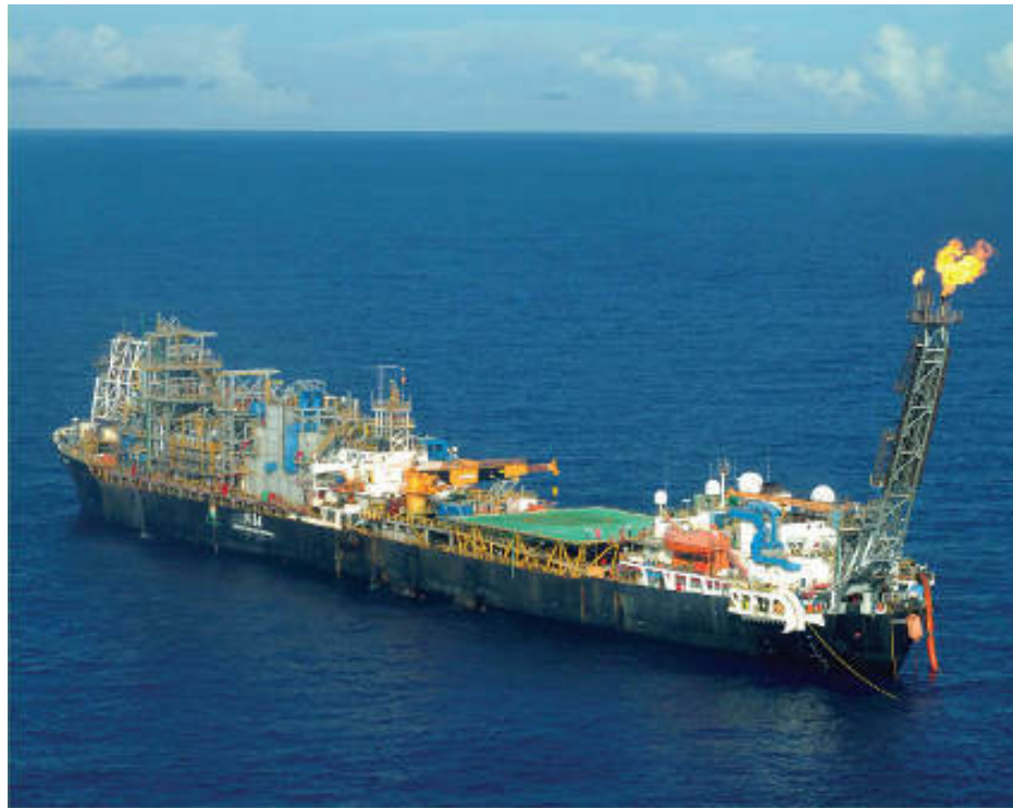
Figura 11: Navio-plataforma P-34 que extrai óleo da camada pré-sal. Fonte: Blog do Planalto.
