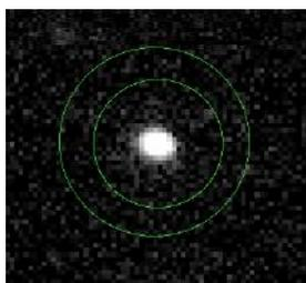
Figure 6.14: Ilustração de uma possível região anular para o cálculo local da contribuição de céu. Essa contribuição será extraída do objeto e posteriormente será realizada sua fotometria.
