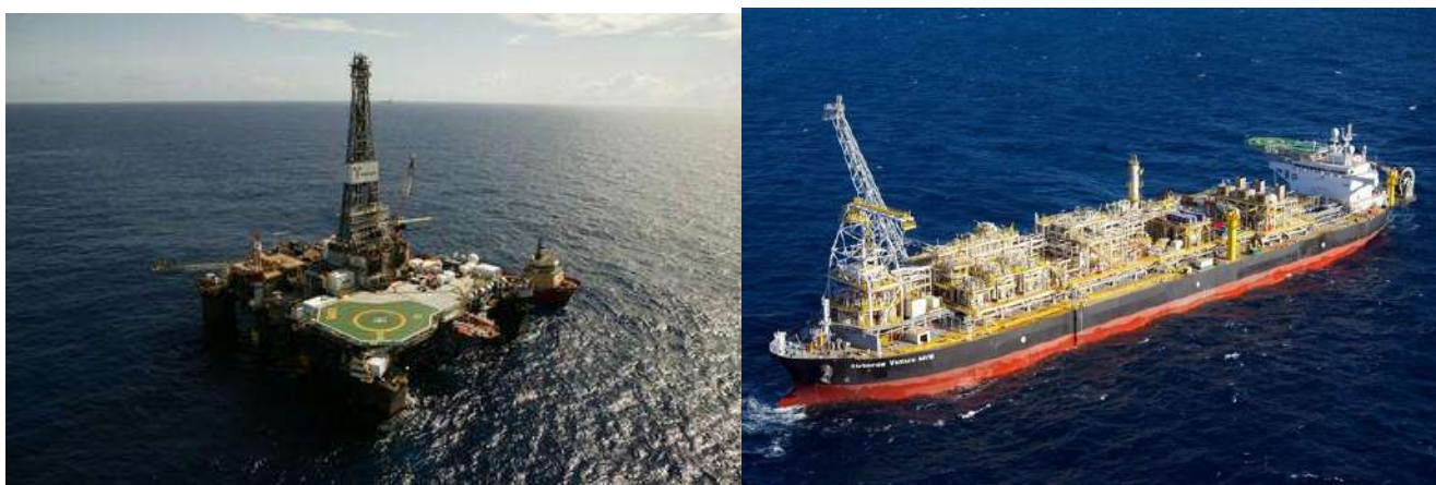
Figura 1.1 – Plataforma SS à esquerda e navio FPSO à direita.
