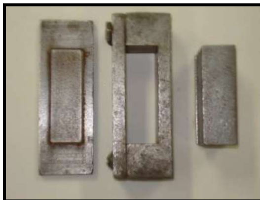
Figura III.3 – Matriz retangular de aço inox utilizada na compactação dos corpos de prova.
