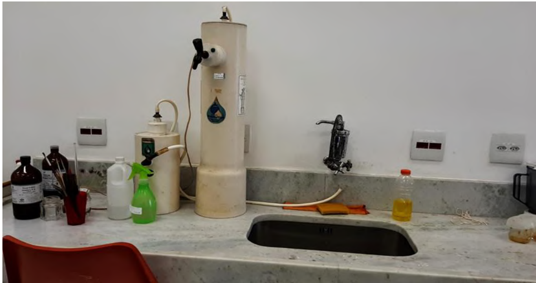
Figura (09) - Detalhe da bancada com produtos químicos e deionizador utilizados em procedimentos de restauração. Fonte (a autora, 2018).
