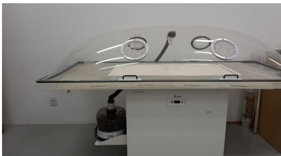
Figura (08) Mesa de sucção com desumidificação. Equipamento usado em procedimento de restauração. Fonte (a autora, 2018).
