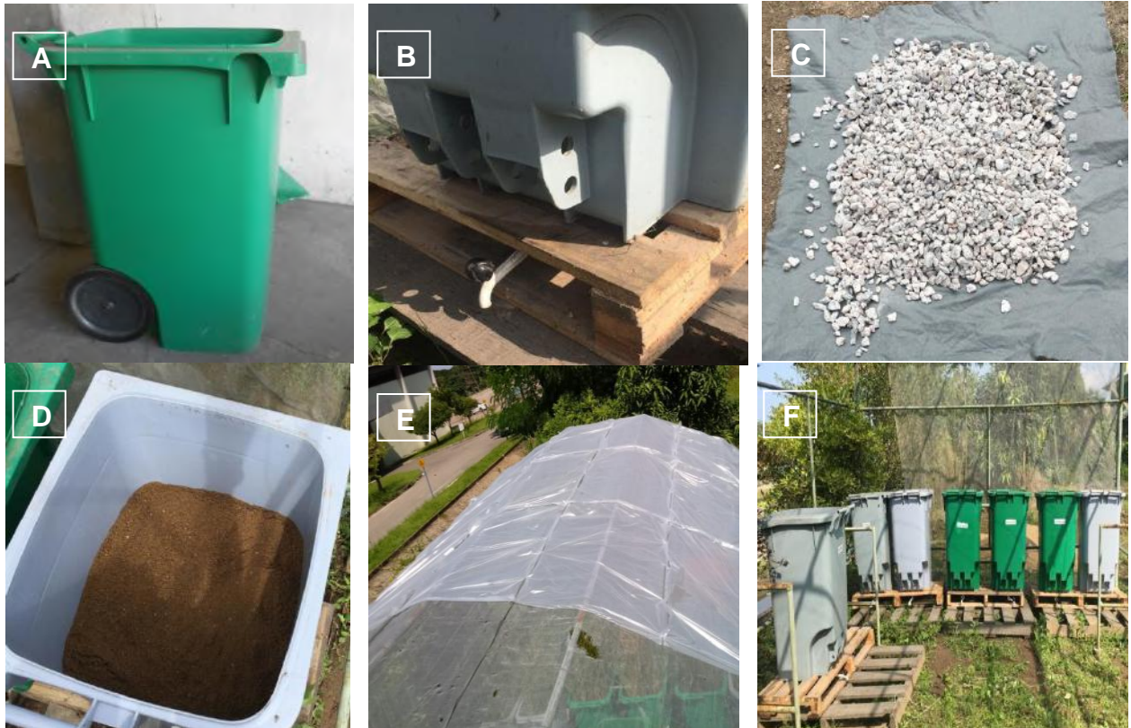
Figura 12 – Visualização das instalações. A. Contêiner de polietileno de alta densidade e capacidade de 240 litros. B. Torneira de drenagem na extremidade inferior do contêiner. C. Brita graduada simples, tamanho dois, sobre manta tecido geotêxtil. D. Areia de leito de rio preenchendo contêiner. E. Toldo impermeável transparente para proteção da infiltração pluvial. F. Sistemas montados, prontos para inserção das plantas.
