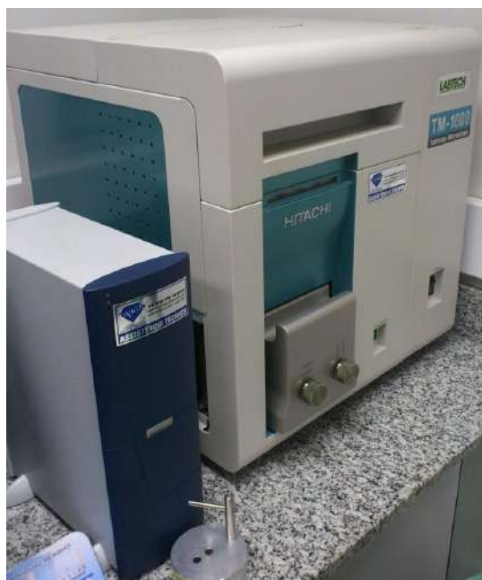
Figura 3.6 – Microscópio eletrônico de varredura.
