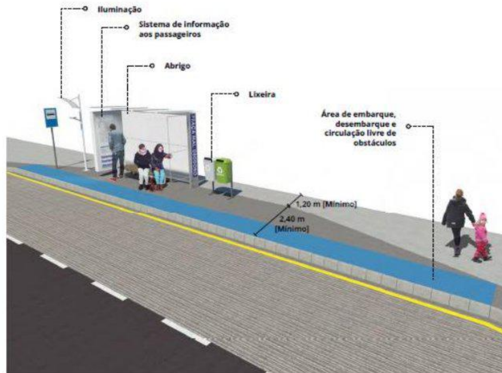
Figura 23 - Elementos que o ponto ônibus deve ter. Fonte: Secretaria Nacional de Mobilidade Urbana - SeMob, 2016
