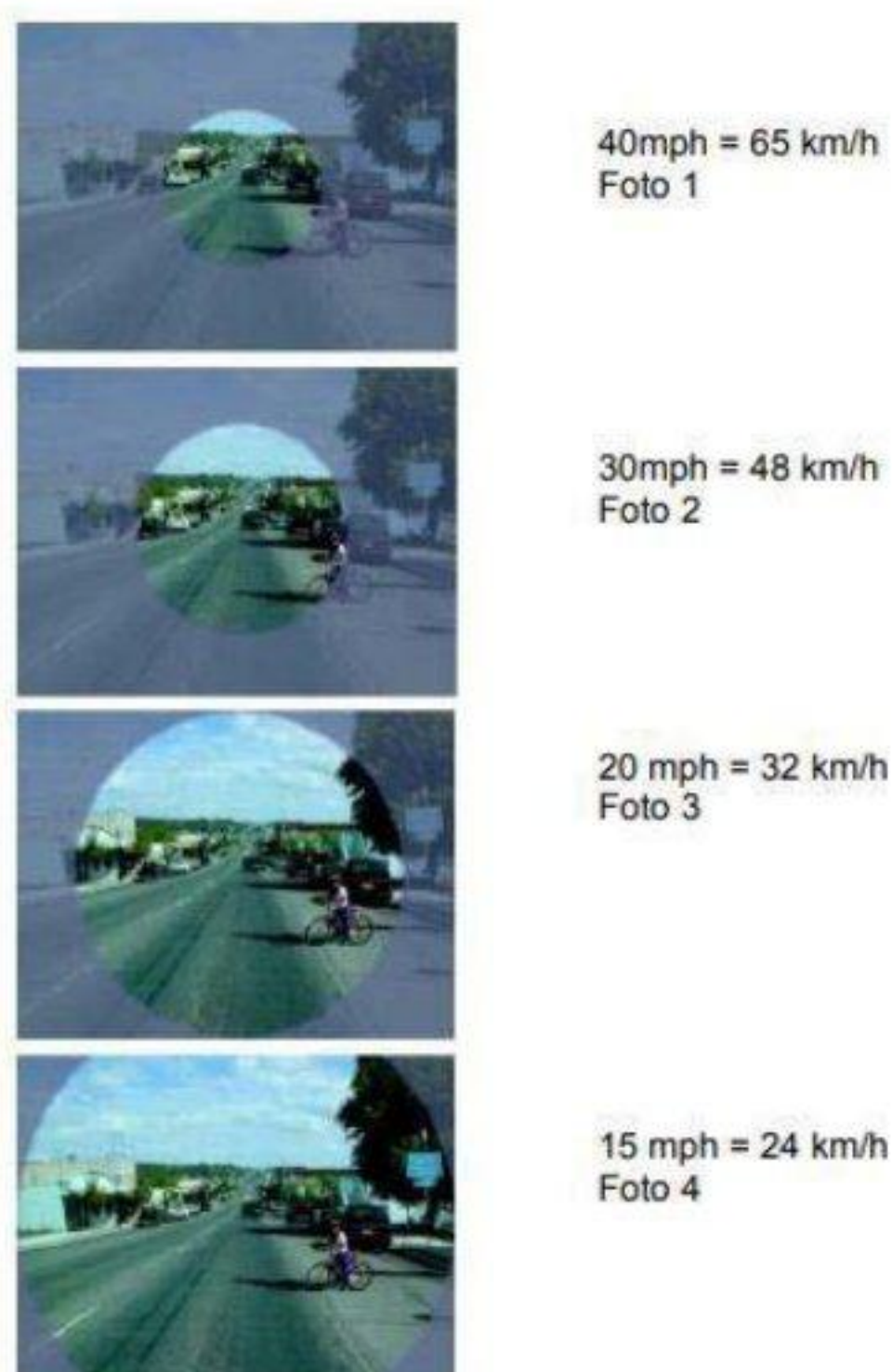
Figura 11 – Capacidade visual do motorista em função da velocidade. Fonte: ODOT-OREGON DEPARTMENT OF TRANSPORTATION,1999
