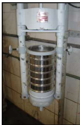
Figura IV.2 – Peneiramento a Úmido (peneiras aço inox da série Tyler).
