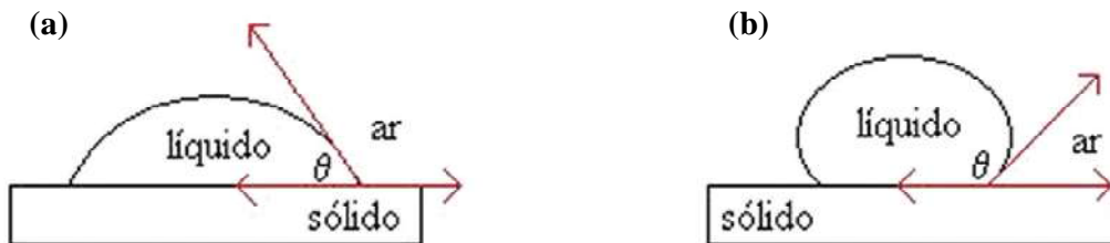
Figura III.2 – Superfícies hidrofílicas (a) apresentam ângulo de contato menor que 90^\circ , enquanto superfícies hidrofóbicas (b) apresentam ângulo de contato maior que 90^\circ .
