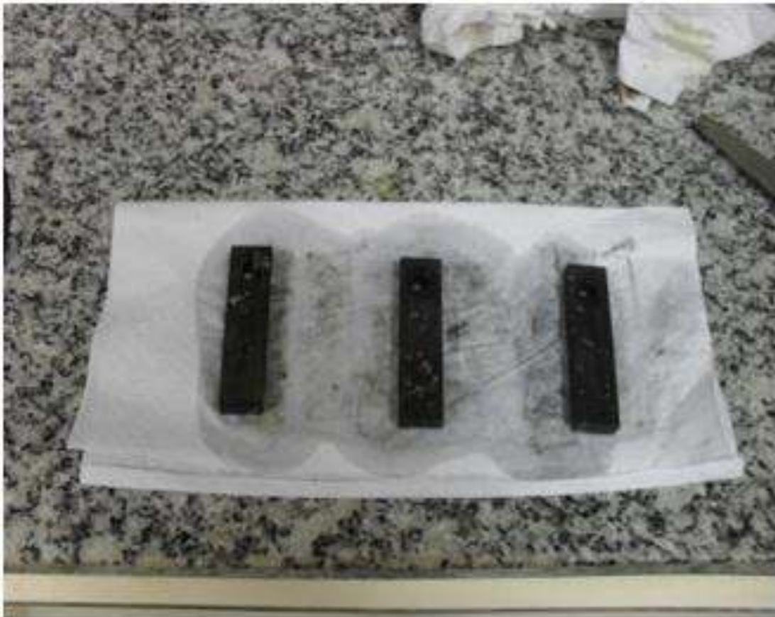
Figura 15 – (a) Cupons de aço carbono AISI 1020 e (b) API 5L grau B ao final do ensaio de imersão de laboratório (17 dias) em meio estagnado.
