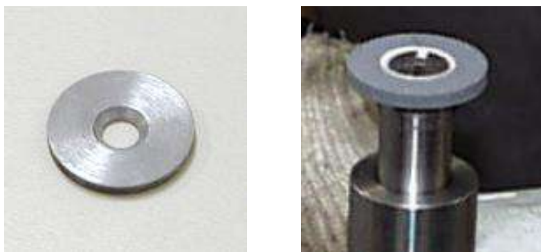
Figura 5 – Cupom por Perda de Massa de aço-carbono (Relatório de Integridade de Dutos – Transpetro, 2011)
