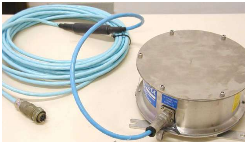
Figura 7 – Estação de aquisição de dados com cabo de conexão (Relatório de Integridade de Dutos - Transpetro, 2011)
