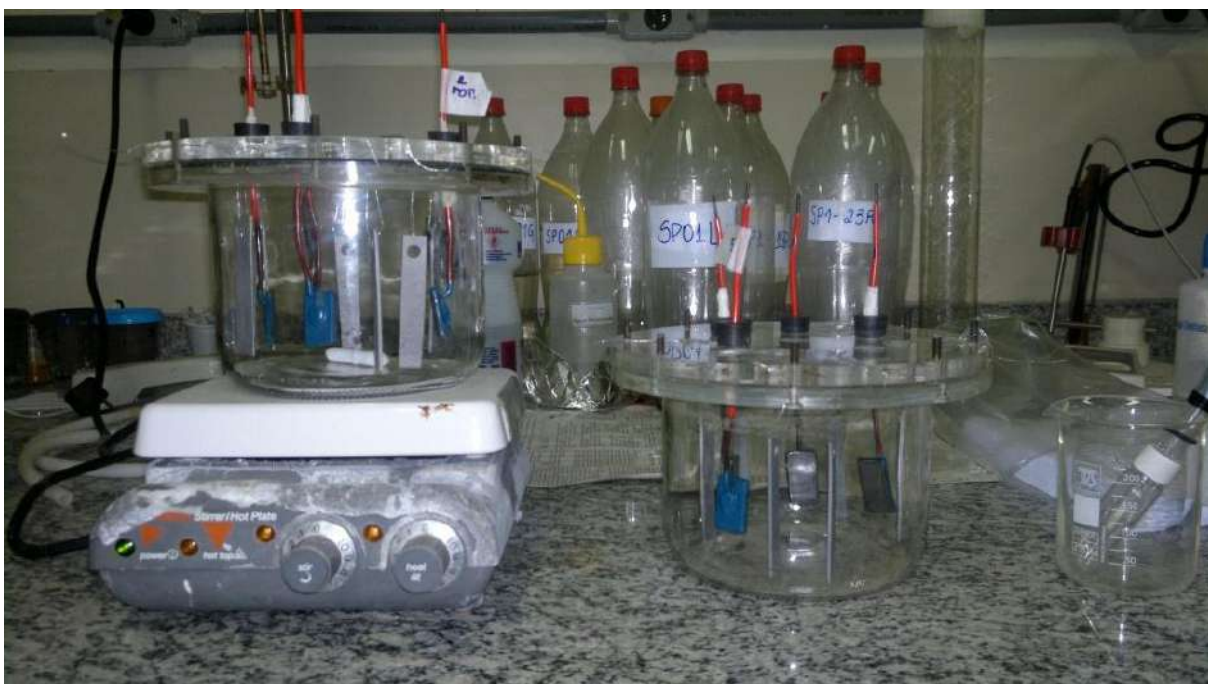
Figura 14 – Cupons de perda de massa e corpos-de-prova para acompanhamento de Potencial Eletroquímico anteriormente ao início dos experimentos: à esquerda observa-se a cuba montada para experimento sob agitação e à direita, cuba montada para experimento sob estagnação
