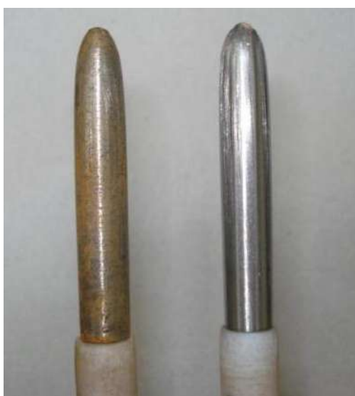
Figura 10– Corpo-de-prova corroído e não corroído após a realização do ensaio NACE (Relatório de Integridade de Dutos - Transpetro, 2011)
