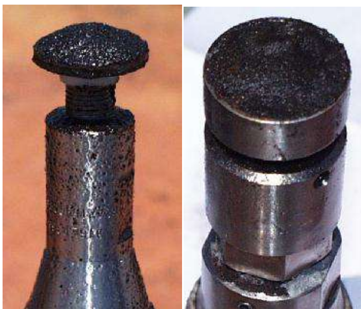
Figura 8 – Resíduo sobre cupom por PM e sonda de RE respectivamente (Relatório de Integridade de Dutos - Transpetro, 2011)
