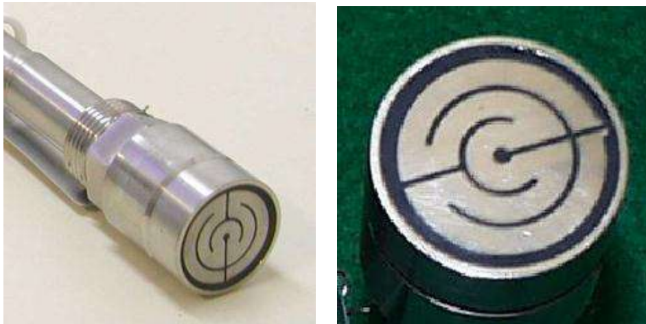
Figura 6 – Sonda Corrossimétrica de Resistência Elétrica (Relatório de Integridade de Dutos - Transpetro, 2011)
