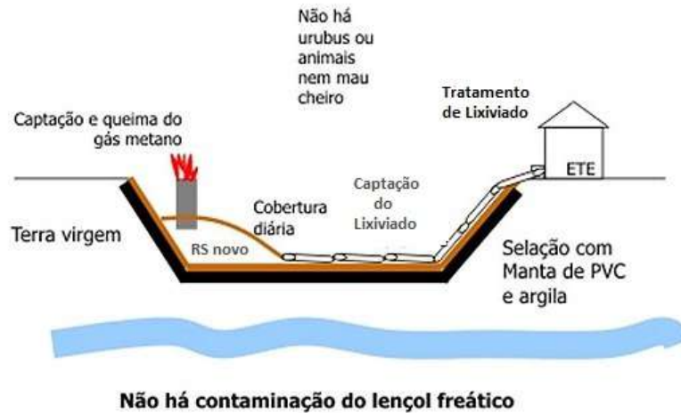
Figura 4: Visão Esquemática de um Aterro Sanitário. Fonte: Site 10.
