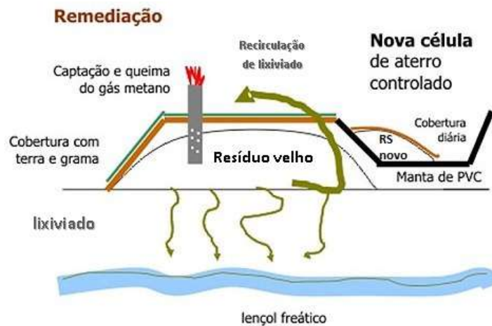
Figura 3: Visão Esquemática de um Aterro Controlado. Fonte: Site 10.
