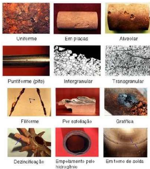
Figura III. 1- Formas de Corrosão (GENTIL, 2011).
