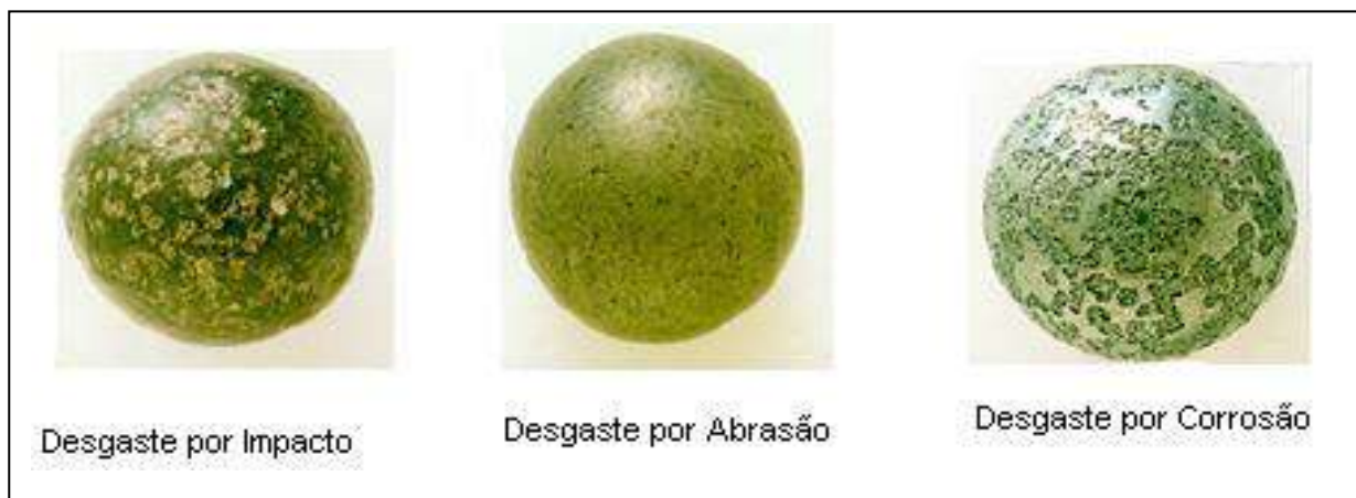
Figura 5.7 - Desgaste de corpos moedores (Silva, 2007)
