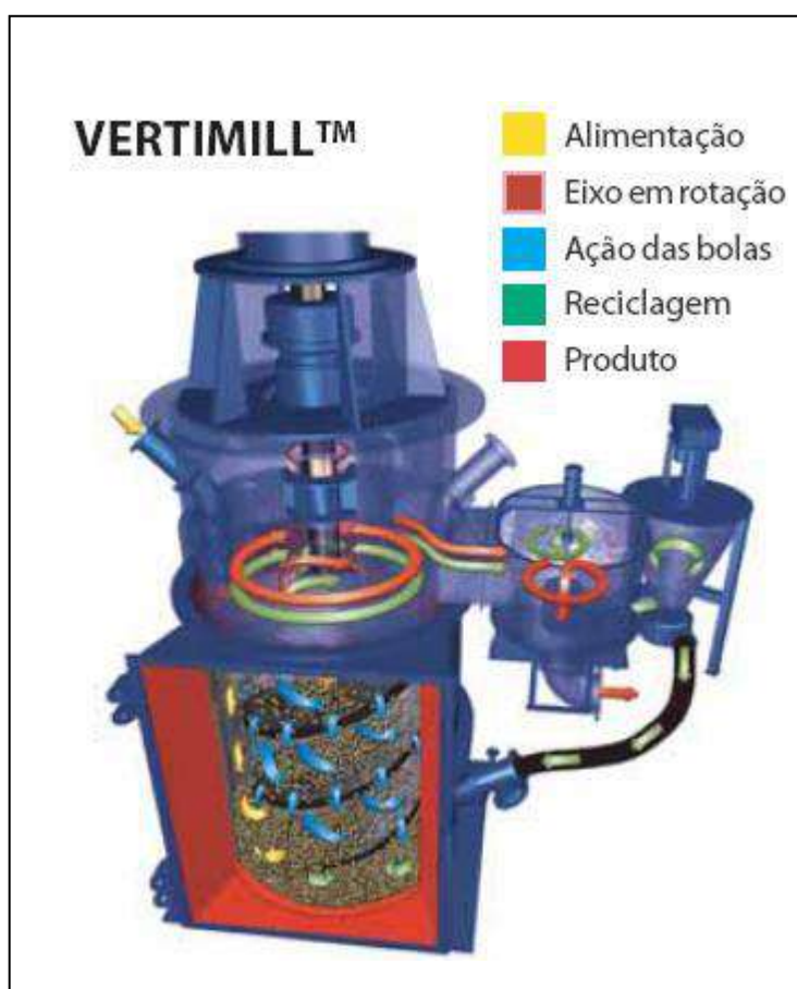
Figura 2.16 - Esquema de moagem do VERTIMILL. (Metso, 2011)
