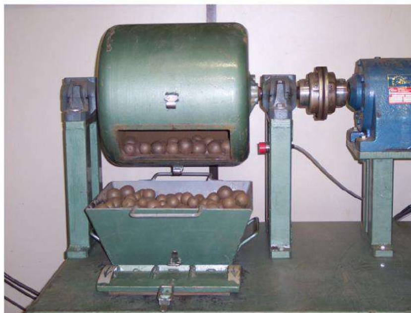
Figura 4.1 - Moinho de bolas padronizado para o ensaio de Bond para determinar a moabilidade (Silva, 2007)
