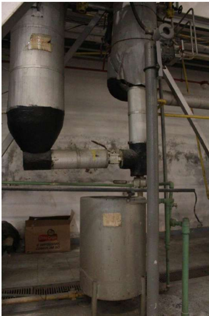
Figura 17 – Fundo da coluna de destilação e refervedor.
