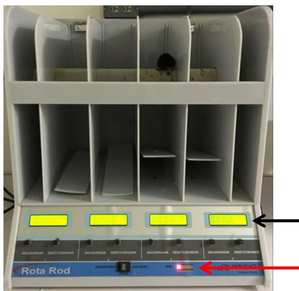
**Figura 8. Rotarod.** Aparelho utilizado para avaliar a função motora e o equilíbrio dos camundongos. Os animais são colocados no cilindro rotatório para correr em aceleração. A seta vermelha indica a velocidade que vai aumentando gradualmente, e a seta preta indica o painel onde o tempo de corrida é cronometrado. Imagem tirada pelo autor.
