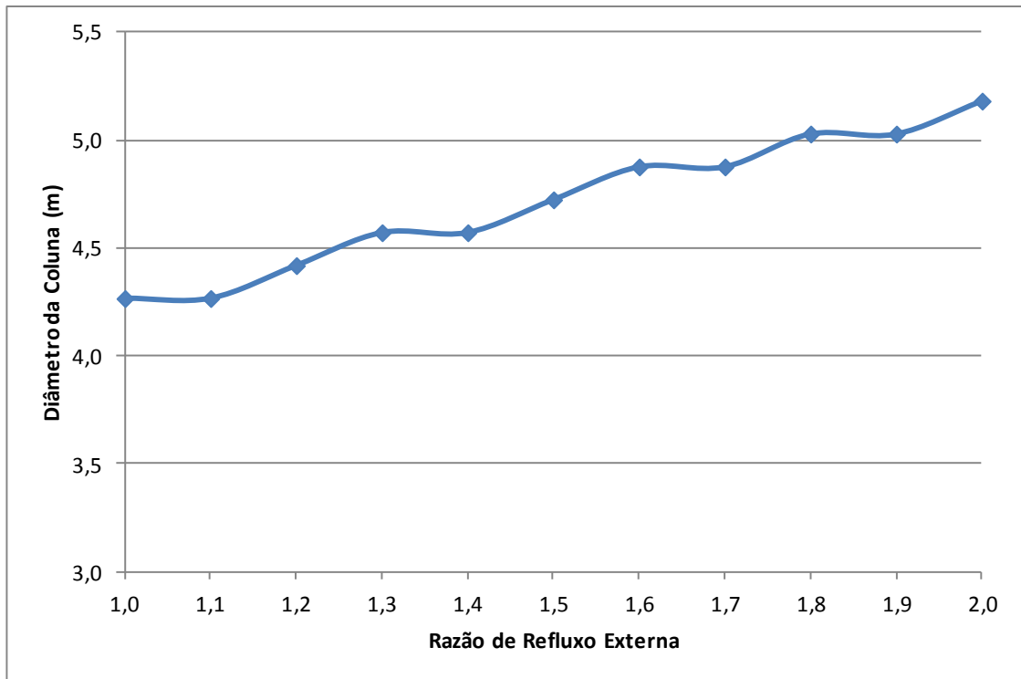
Figura V-7 – Influência da Razão de Refluxo Externa e Diâmetro da Coluna ( Layout II )
