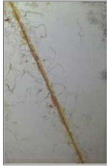
Figura II.7 - Corrosão filiforme-filamentos se propagando de risco em chapa de aço (GENTIL, 2007).
