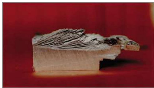
Figura II.8 - Peça de alumínio oxidada por esfoliação (GENTIL, 2007).
