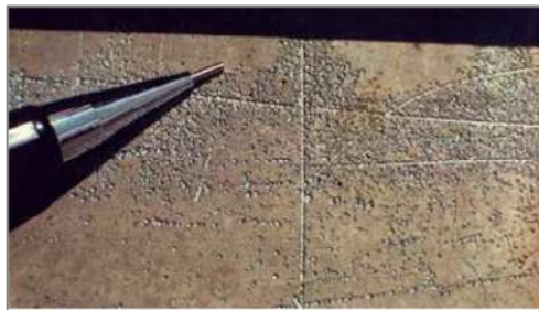
Figura II.4 - Corrosão por pite em aço inoxidável (GENTIL, 2007).
