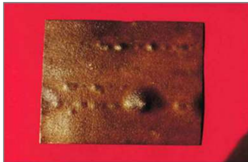
Figura II.11 - Placa que sofreu empolamento por hidrogênio (GENTIL, 2007).
