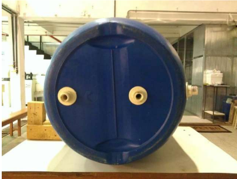
Figura 3.8: Furos flangeados no fundo dos tanques
