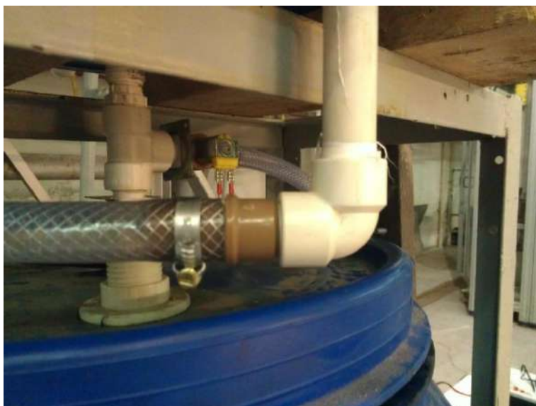
Figura 3.11: Junção entre mangueira e conexão de PVC
