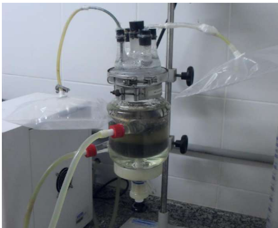
Figura 3.2: Biorreator utilizado para a digestão anaeróbia de resíduos alimentares.
