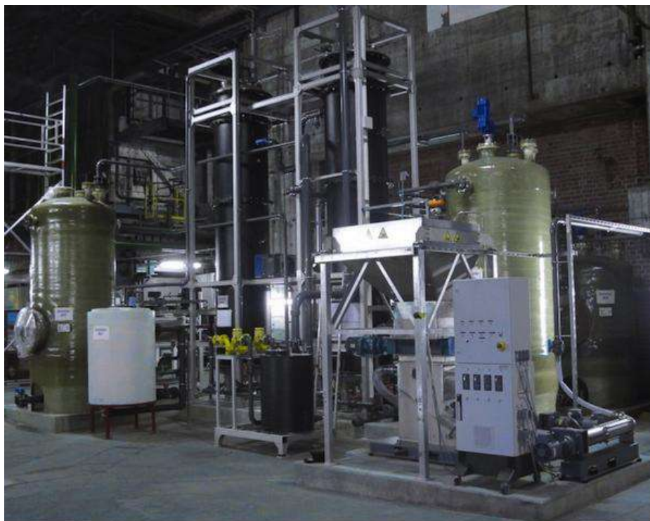
Figura 2.5: Biodigestor em escala piloto para tratamento dos resíduos alimentares em Stutgard, Alemanha (AKIRA, 2012).
