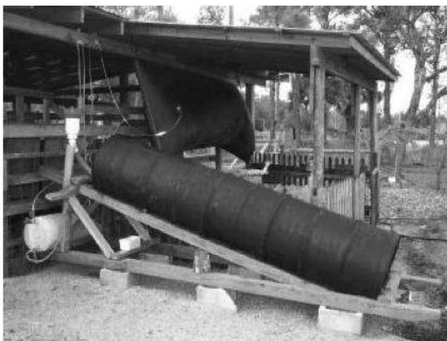
Figura 2.4: Biodigestor caseiro baseado em um tanque inclinado, e uma bolsa polimérica para coleta dos gases (FORST, 2002).
