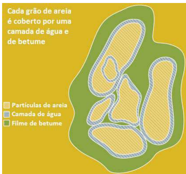
Figura 23: Esquema da areia petrolífera
