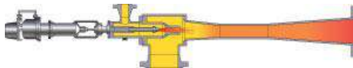
Figura 5: Ejetor operado com bocal móvel (Croll Reynolds, 2011 b).
