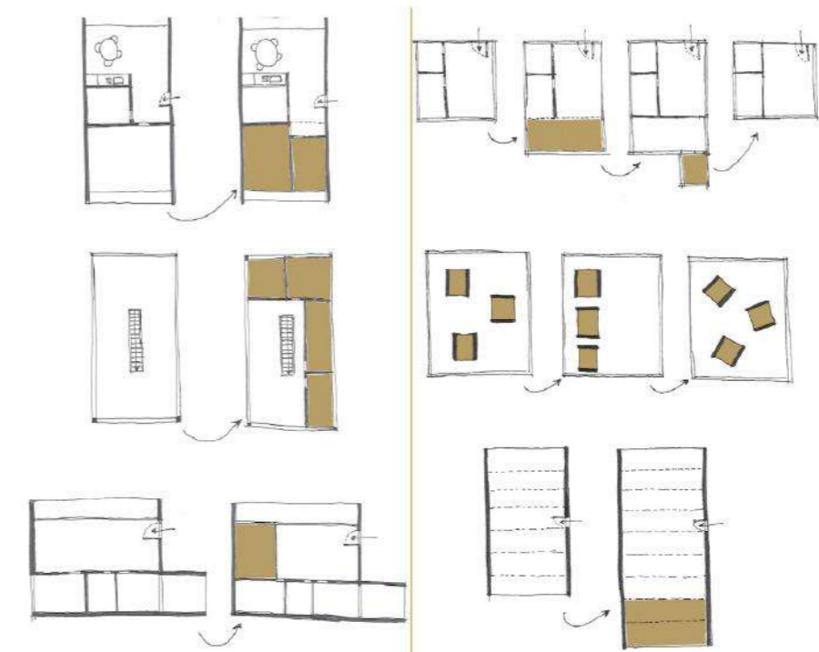
Figura 4 – O esquema desenhado à esquerda retrata o que se entende enquanto Arquitetura Evolutiva, enquanto que o da direita representa a Arquitetura Evolutiva Modular.
