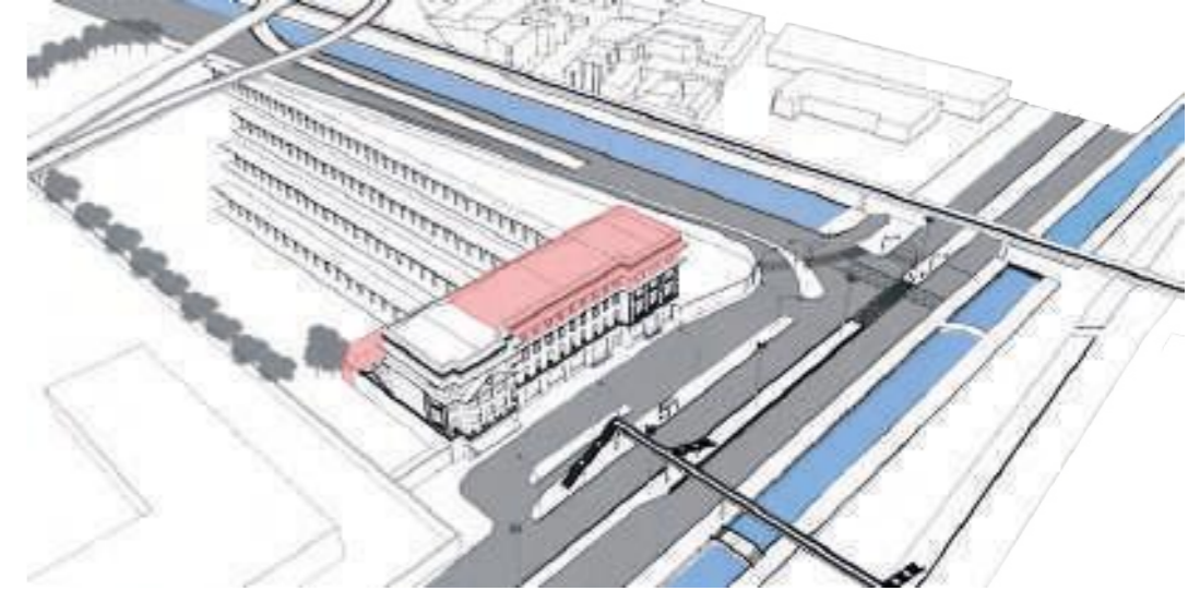
Elementos a serem demolido
