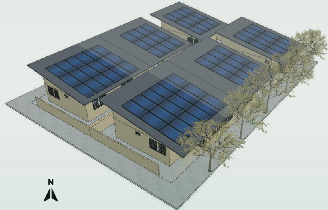
Com a perspectiva isométrica é possível observar a relação entre as edificações projetados no seu exterior e como funciona seus modelos geminados,, trouxemos o projeto de cada uma das tipologias para melhor representação grafica assim como o a projeção do telhado, em apenas uma água para captação das chuvas por apenas uma calha e todos virados para o mesmo lado com melhor aproveitamento da insolação para as placas voltaicas.
