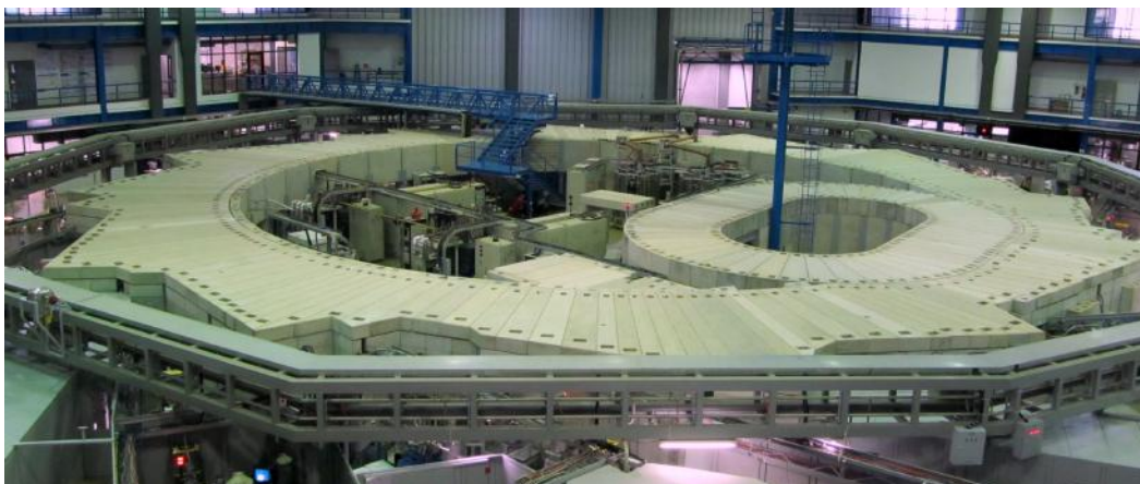
FIGURA 2.2: Imagem do anel de armazenamento do LNLS que mostra as linhas de luz em cada tangente do anel. Retirado de http://lnls.cnpem.br/accelerators/accelerator-division/rf/the-rf-systems-at-the-lnls-synchrotron-light-source/
