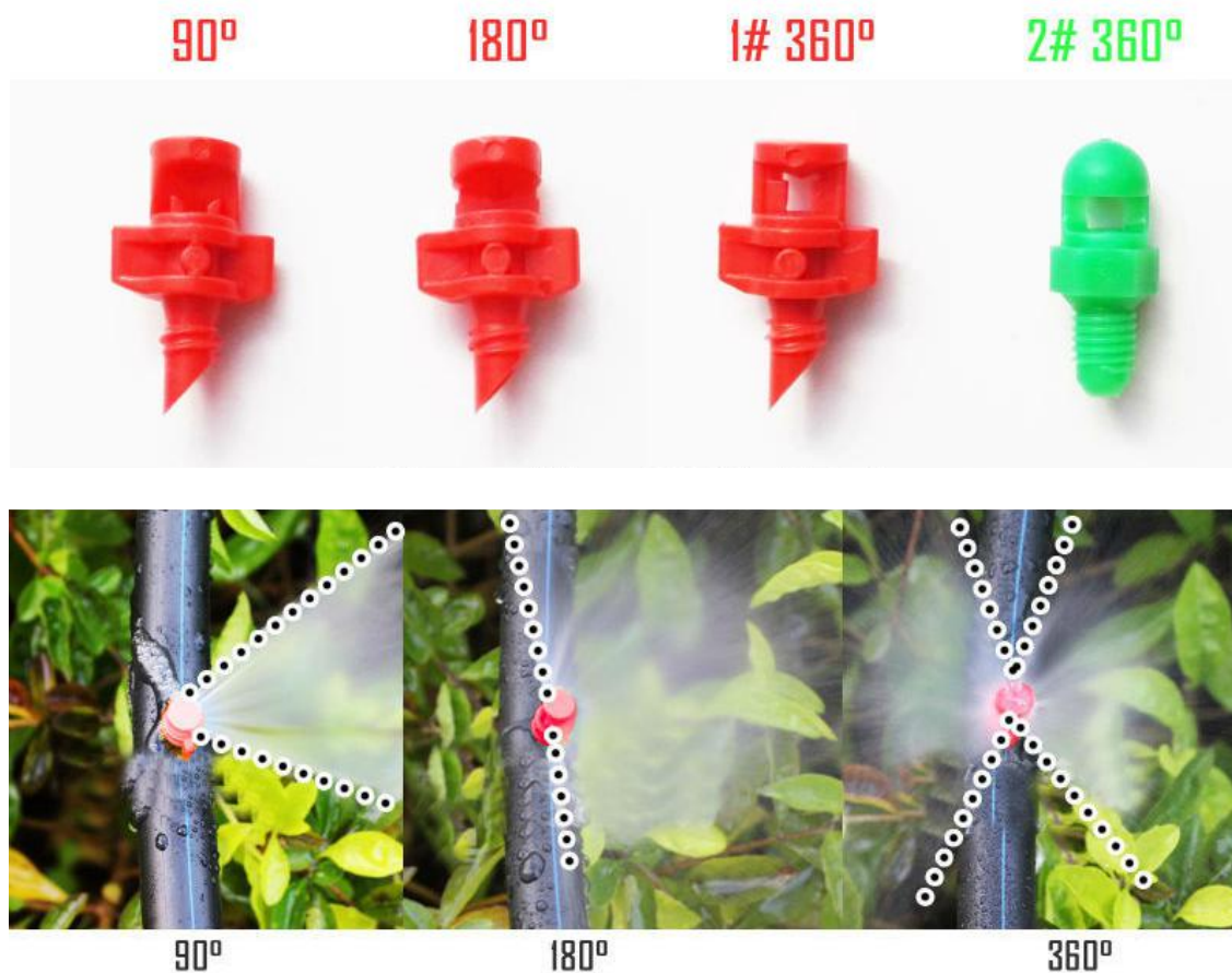
Figura 45: bicos pulverizadores e suas angulações
