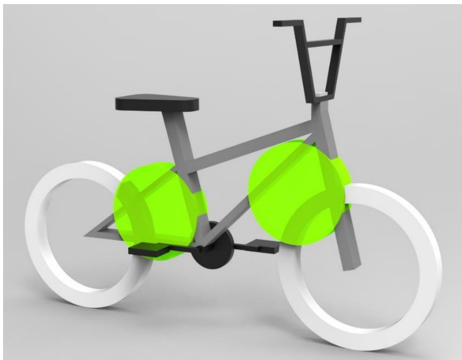
Figura 81– Delimitações da Região Ideal de Ancoragem na Bicicleta Aro 20
