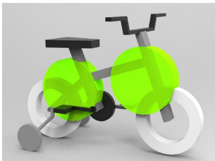
Figura 80 – Delimitações da Região Ideal de Ancoragem na Bicicleta Aro 12
