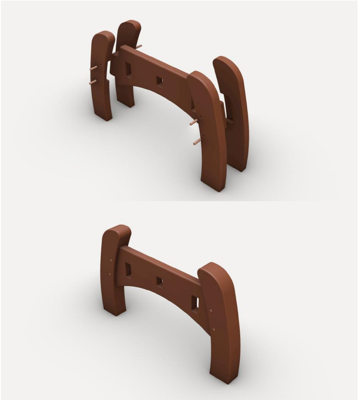
Figura 72 - Detalhe - Encaixe dos pés do Pufe
