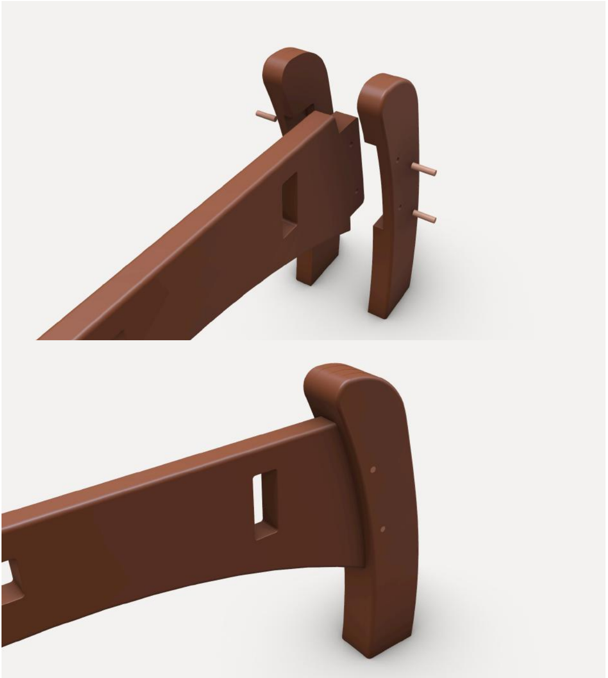
Figura 63 - Detalhe - Encaixe dos pés posteriores
