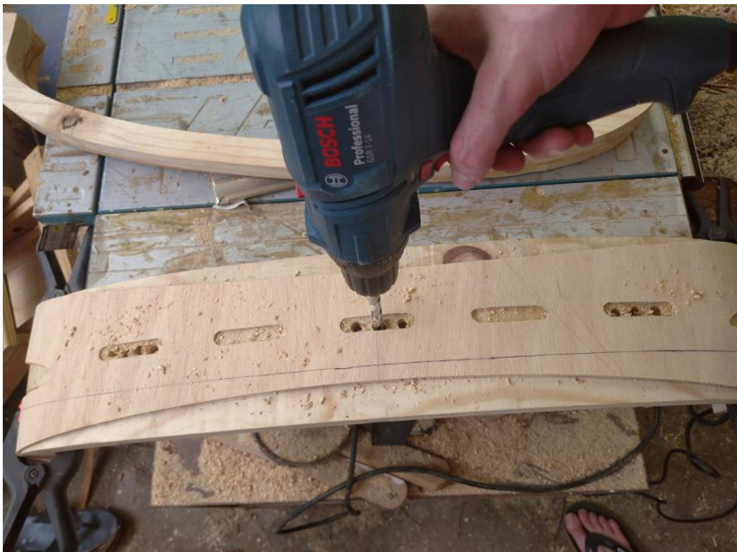
Figura 123 - Encosto - Furos para passagem das Tiras de Couro
