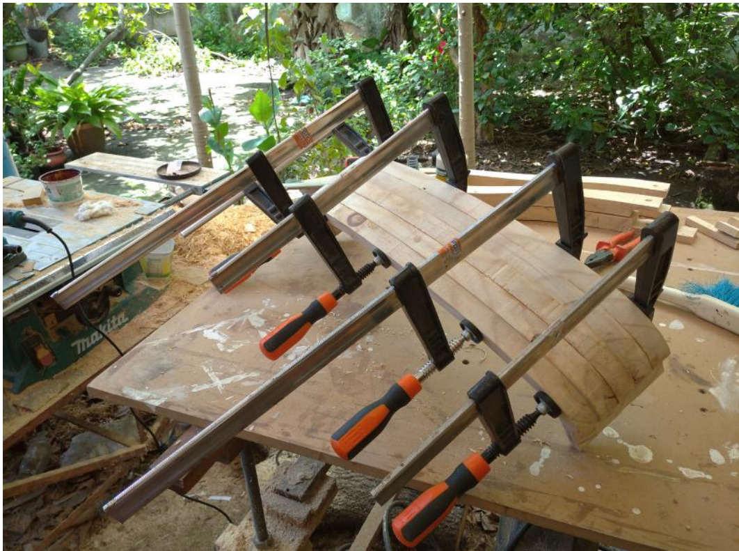
Figura 121 - Colagem dos Perfis do Encosto
