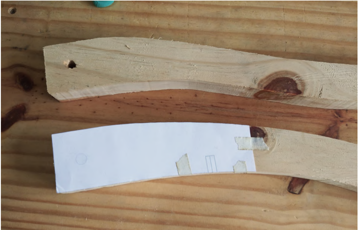
Figura 114 - marcação de cavilhas - 01
