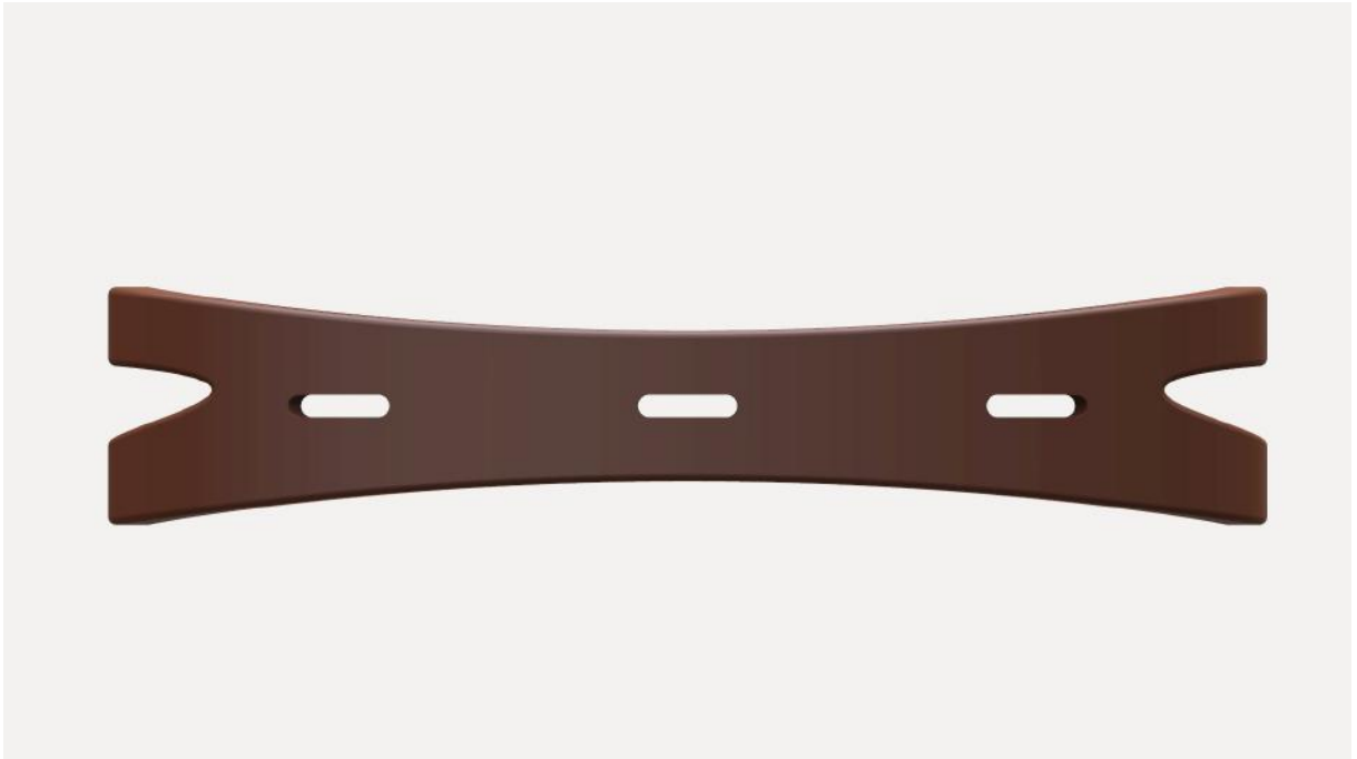
Figura 62 - Detalhe - Furação do encosto
