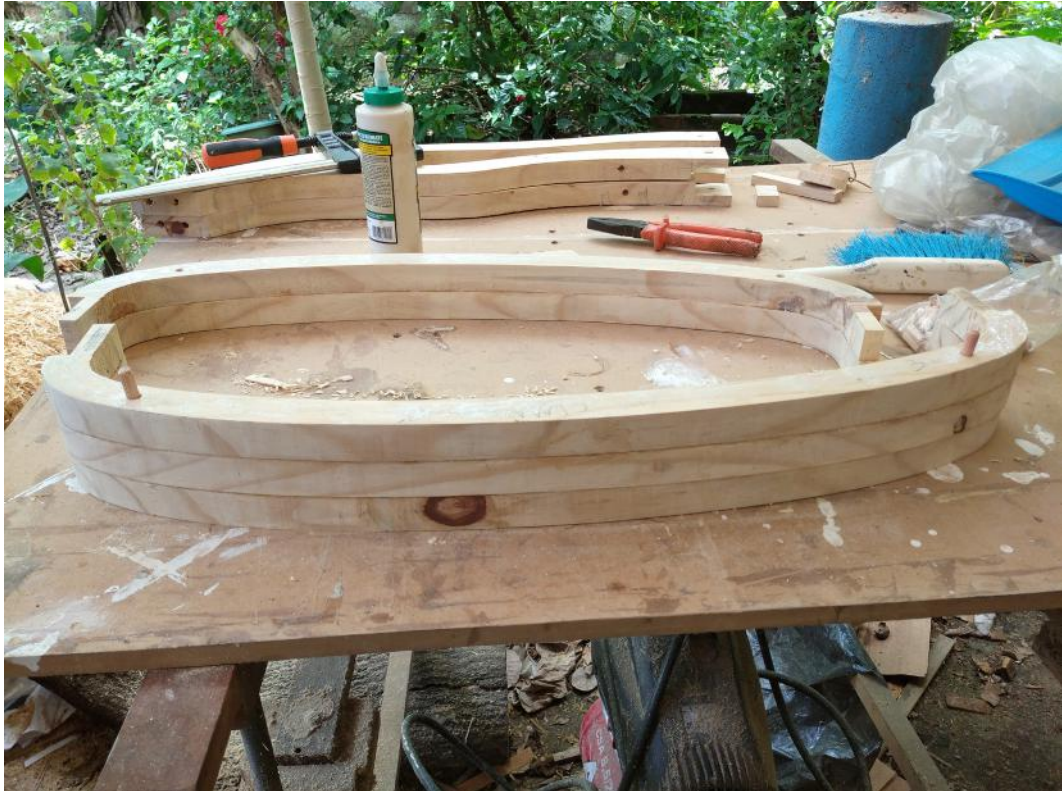
Figura 120 - Perfis do Encosto - Cola e Cavilhas
