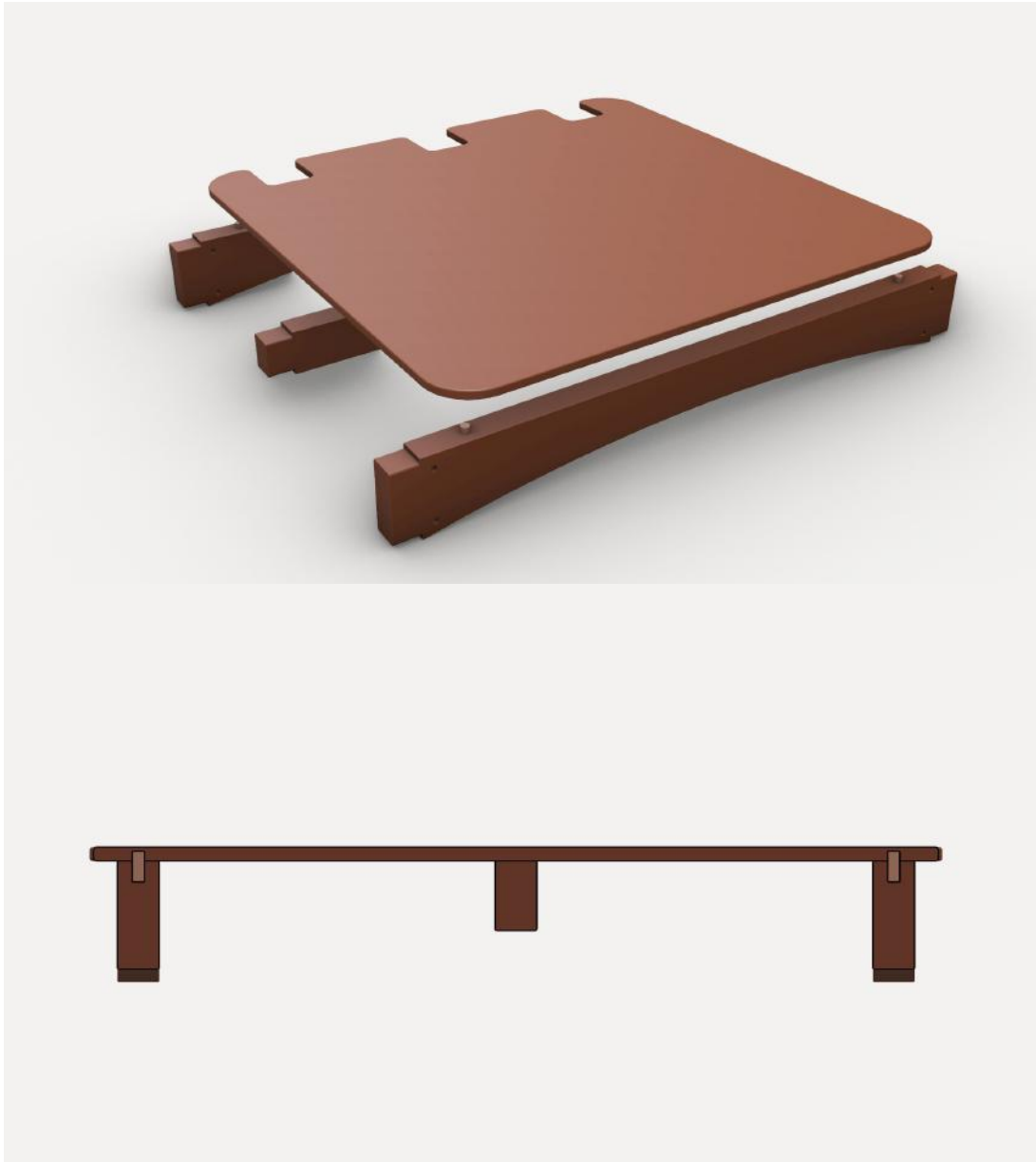
Figura 60 - Detalhe - Encaixe da base do assento nas estruturas transversais
