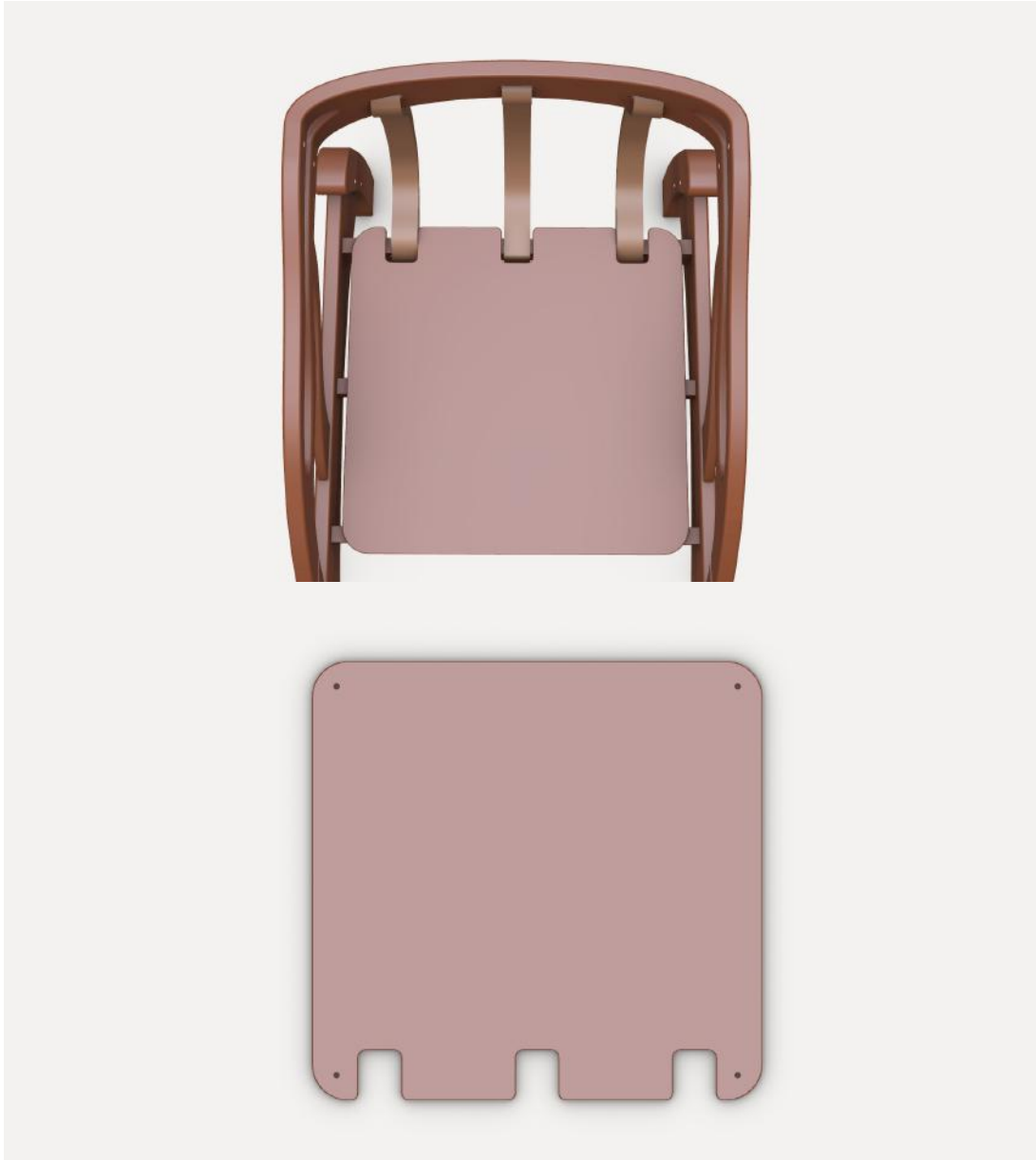
Figura 59 - Detalhe - Base do assento - Desenho e Rebaixos
