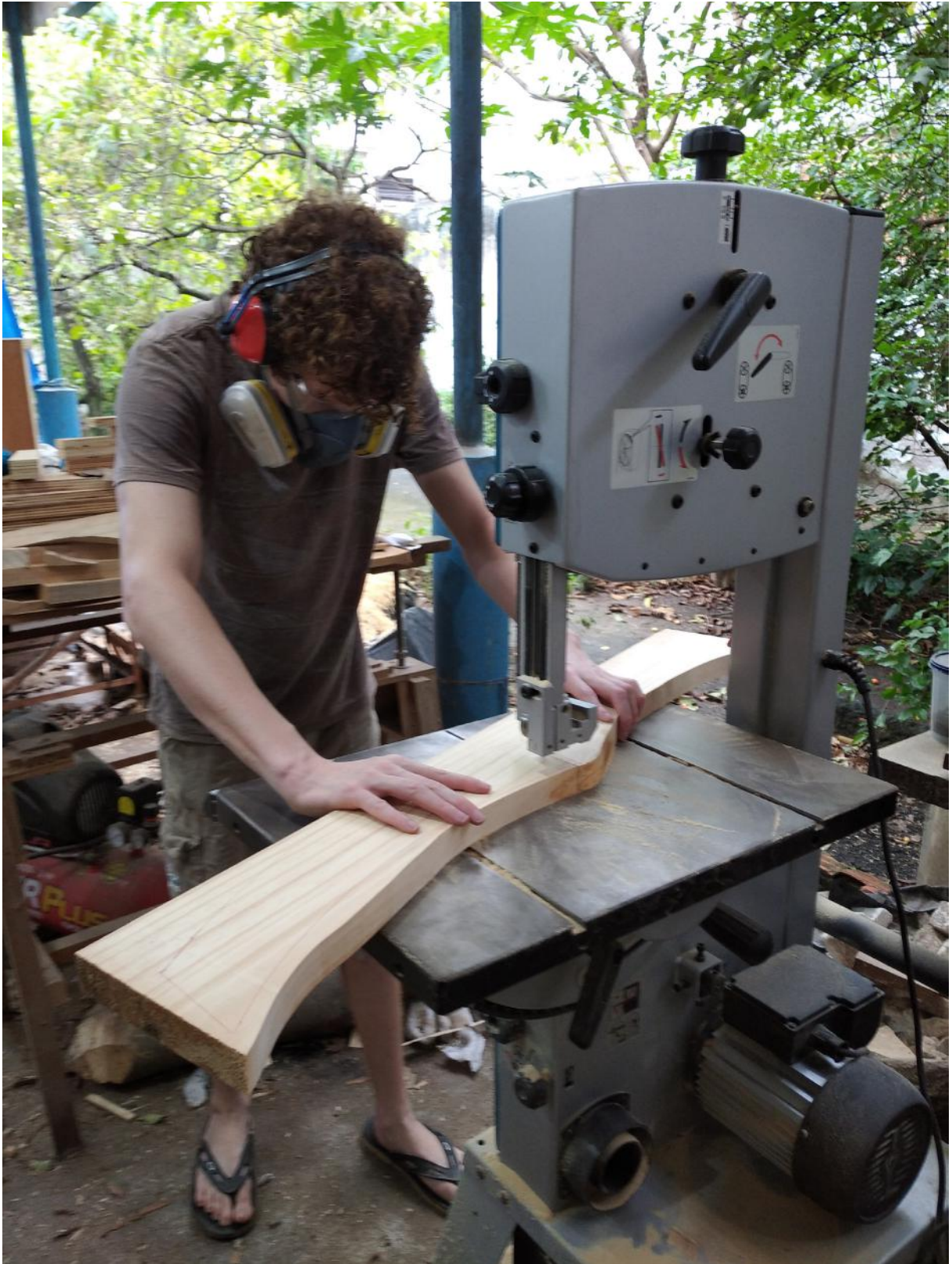
Figura 112 - Cortando uma peça riscada na serra de fita - 02
