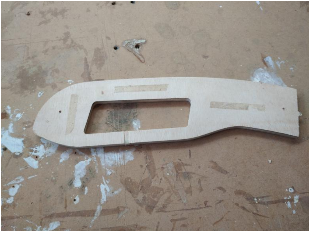
Figura 117 - Segundo gabarito para rebaixo dos Pés Posteriores
