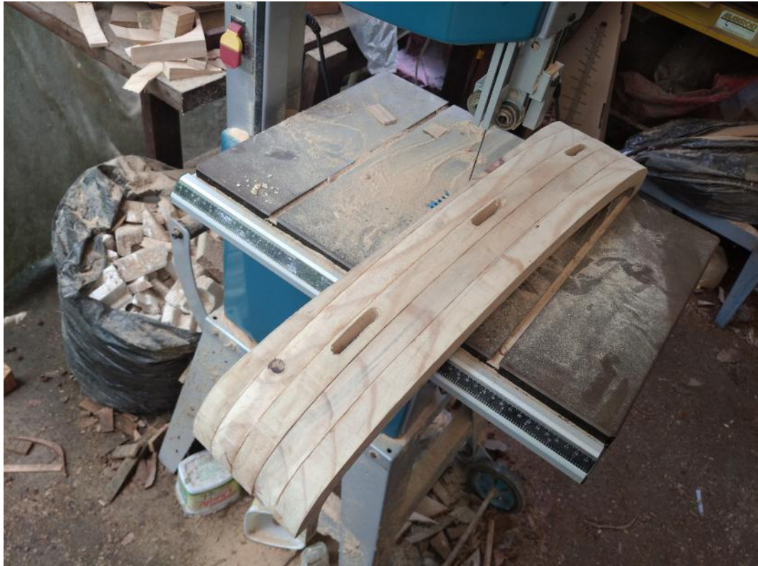
Figura 124 - Encosto - Corte do risco na serra de fita
