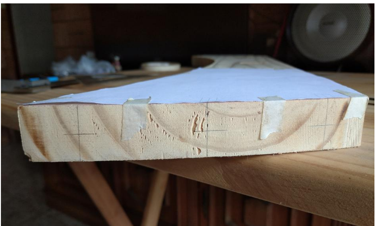
Figura 115 - marcação de cavilhas - 02
