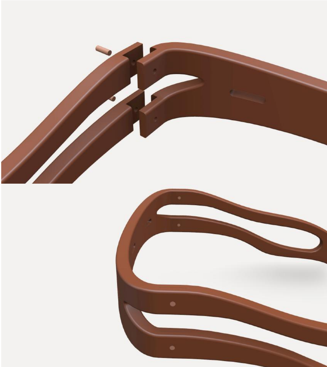
Figura 58 - Detalhe do encaixe do braço com o encosto
