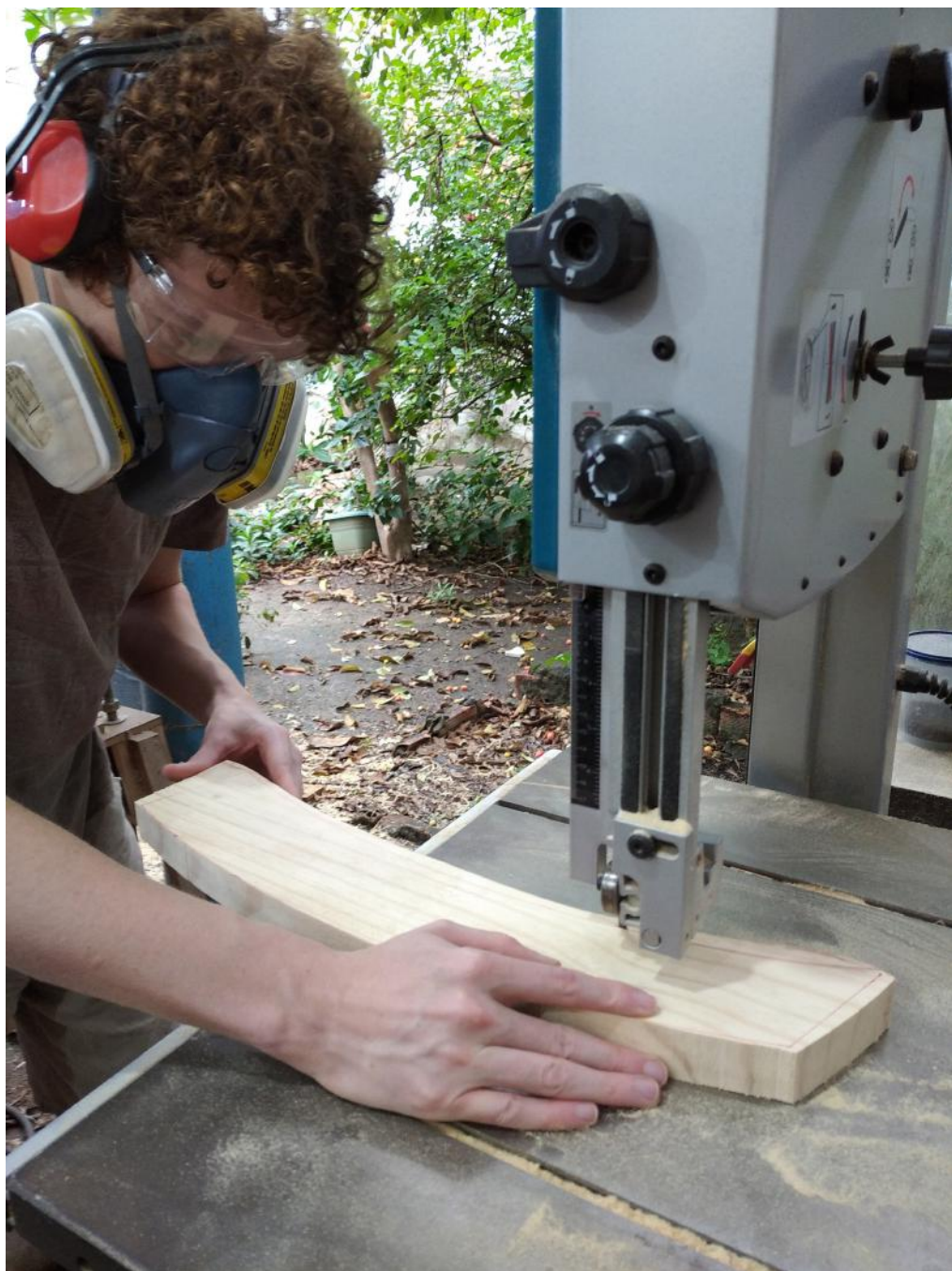
Figura 111 - Cortando uma peça riscada na serra de fita - 01
