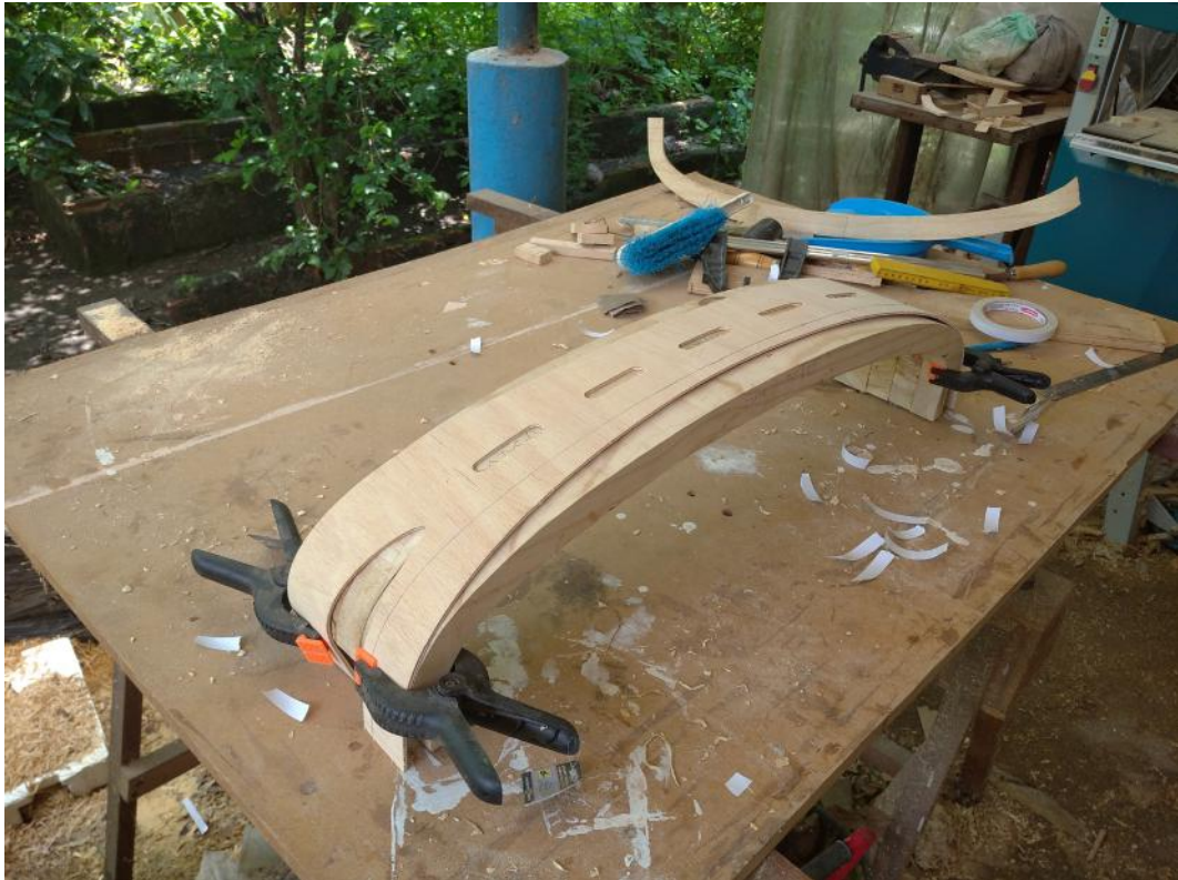
Figura 122 - Encosto com Gabarito de Compensado Flexível
