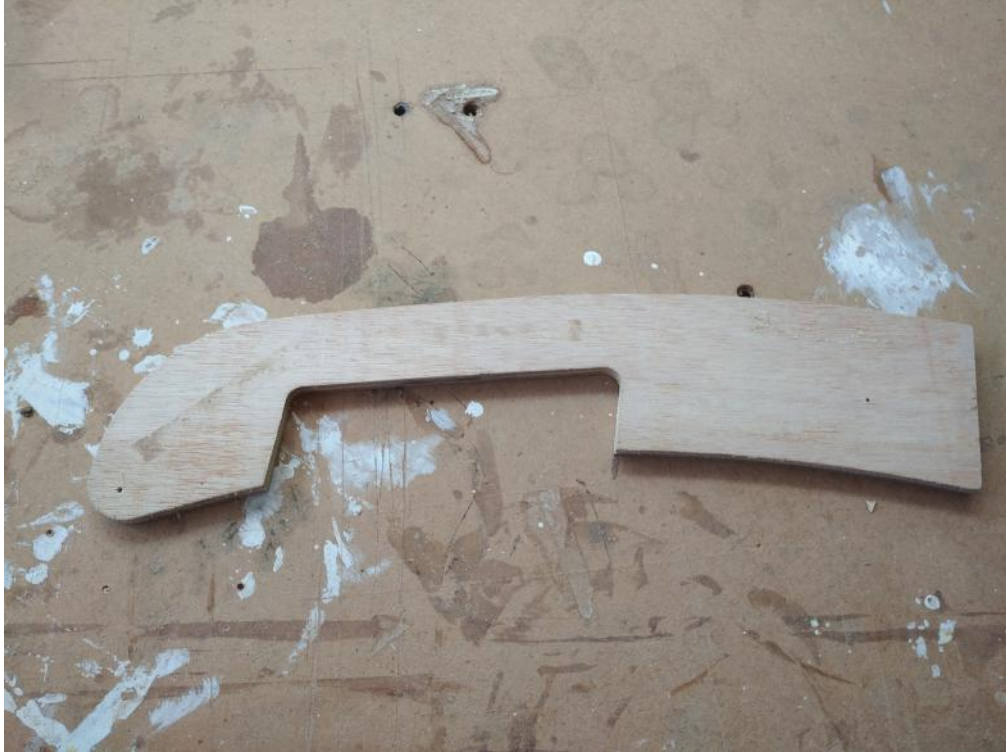
Figura 116 - Primeiro gabarito para rebaixo dos Pés Posteriores
