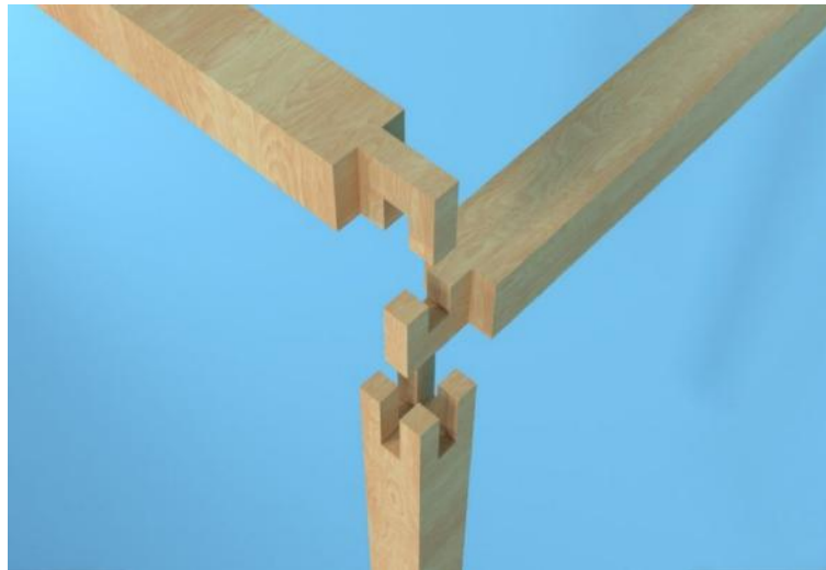
Figura 50: Encaixes japoneses elaborados para a estrutura.
