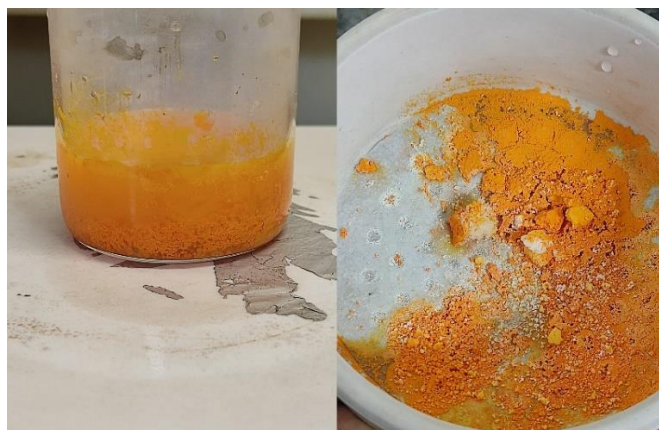
Figura 11 - Aspecto do AsI_3 recém-precipitado, ainda no seio da solução (à esquerda) e filtrado (à direita)
