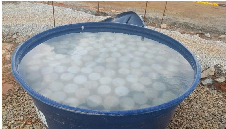
Figura 23 – Corpos de prova em cura úmida após a concretagem
