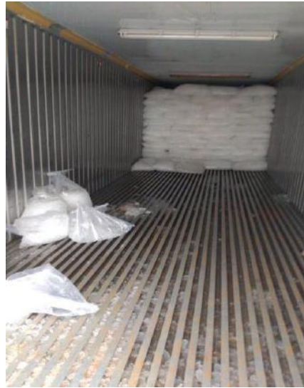
Figura 18 – Container frigorífico utilizado na obra com gelo
