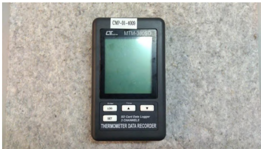
Figura 22 – Termômetro de monitoramento da temperatura do concreto
