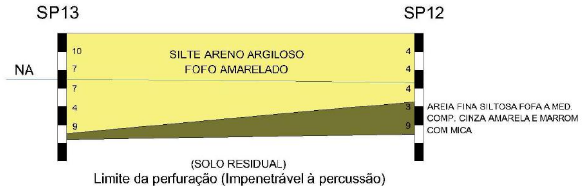
Figura 4-7 - Perfil geotécnico elaborado a partir dos furos de sondagem SP12 e SP13
