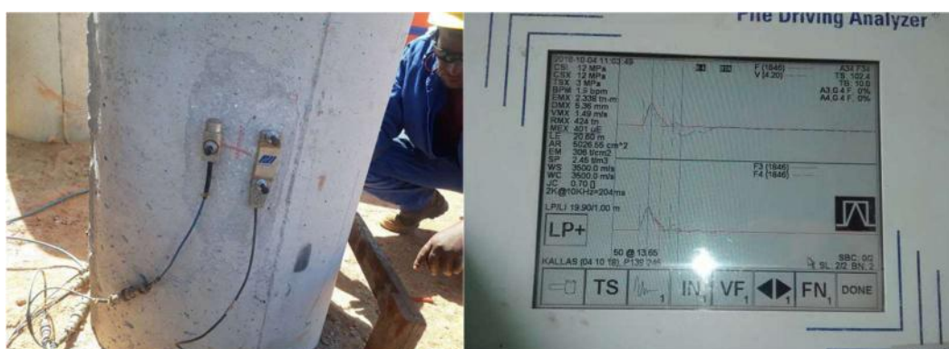
Figura A. 12 - Detalhe dos sensores instalados no fuste da estaca e equipamento de PDA,
