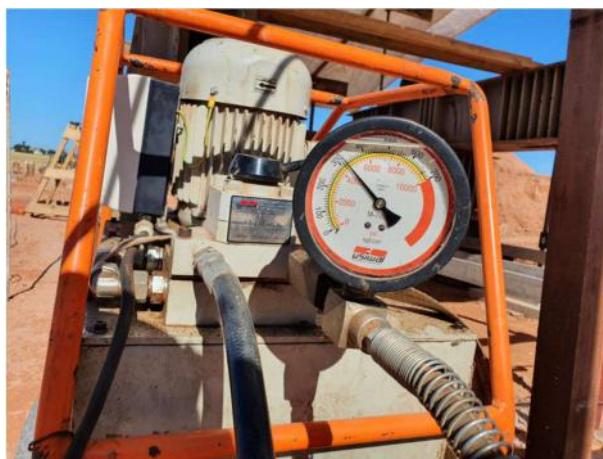
Figura A. 9 - Bomba hidráulica utilizada para incrementos de carga durante as etapas de carregamento e descarregamento da PCE.
