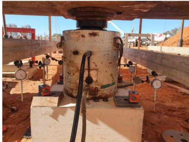
Figura A. 10 - Cilindro hidráulico e extensômetros utilizados durante a PCE
