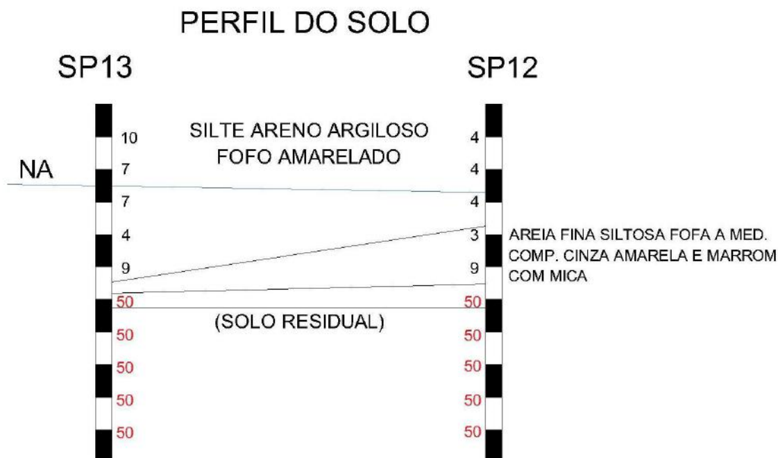
Figura 5-1 – Perfil geotécnico adotado nas análises.
