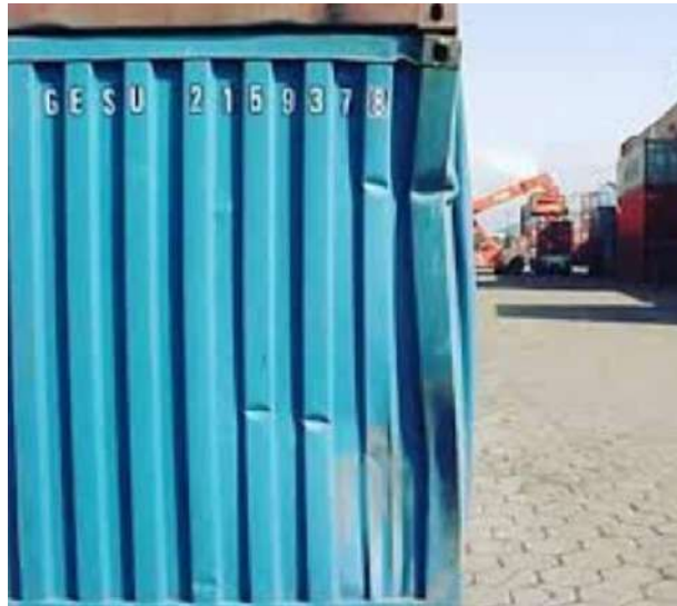
Figura 15 - Estrutura do container danificada
