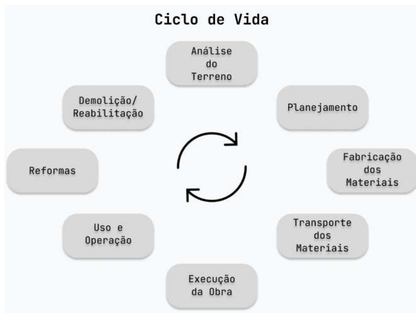
Figura 4 - Ciclo de vida de uma edificação
