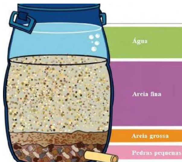
Figura 5 – Ilustração das camadas de um filtro lento
