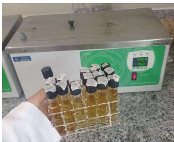
Figura 17 - Amostras inoculadas com caldo EC e aparelho de banho-maria
