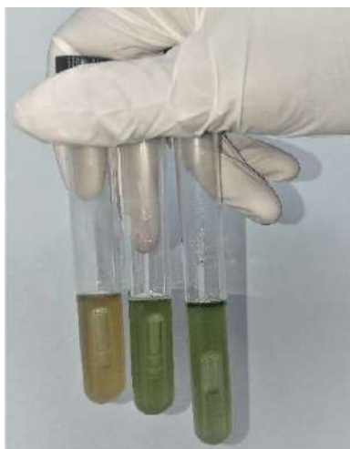
Figura 29 – Tubos com formação de gás nos caldos EC e Verde Brilhante
