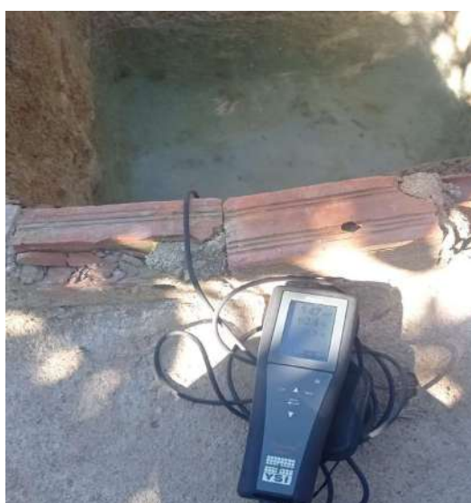
Figura 18 – Oxímetro sendo usado para medição no interior do poço
