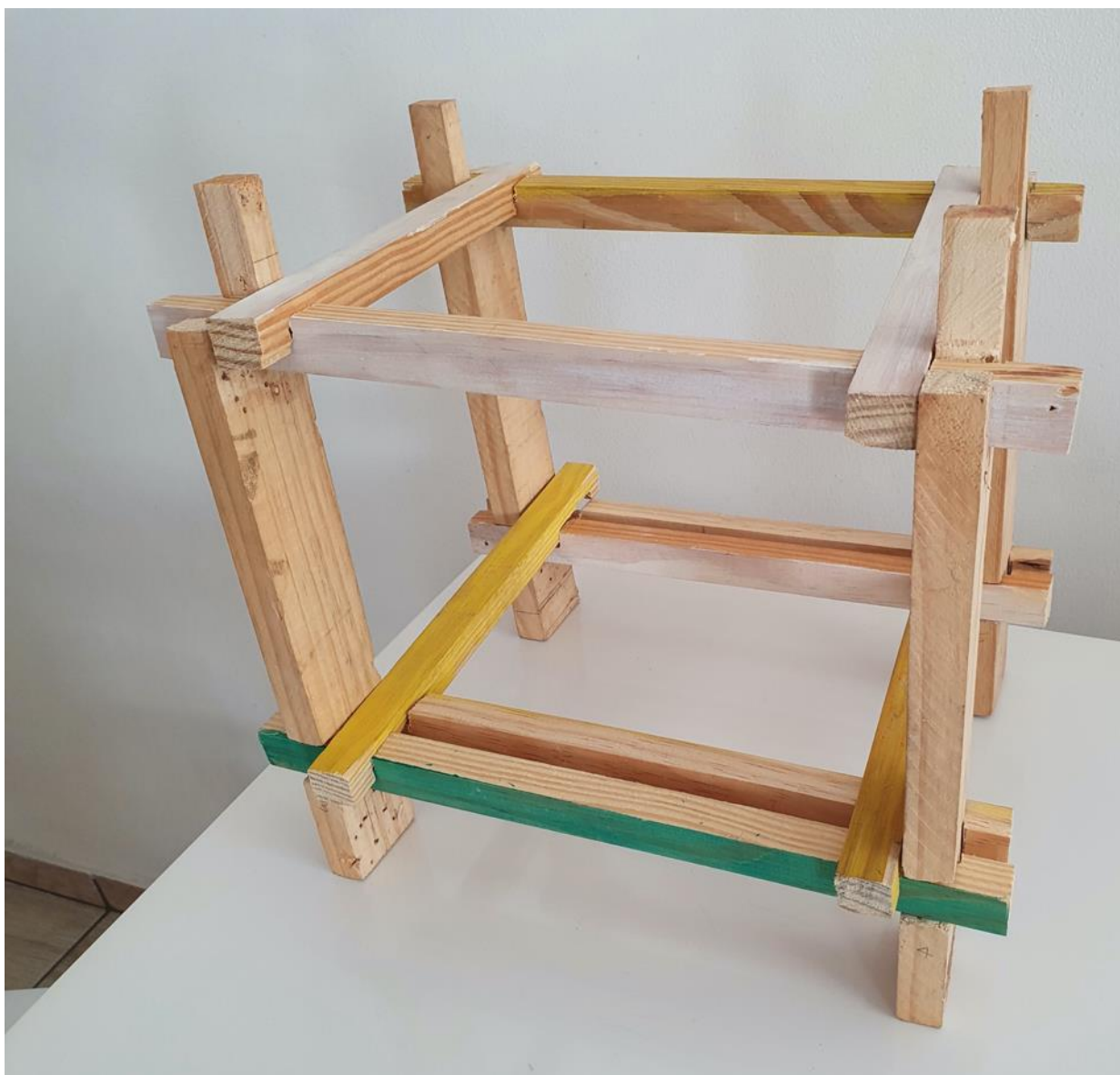
Figura 113: Nova proposta com ligações de trilhos "escondida", montada.
