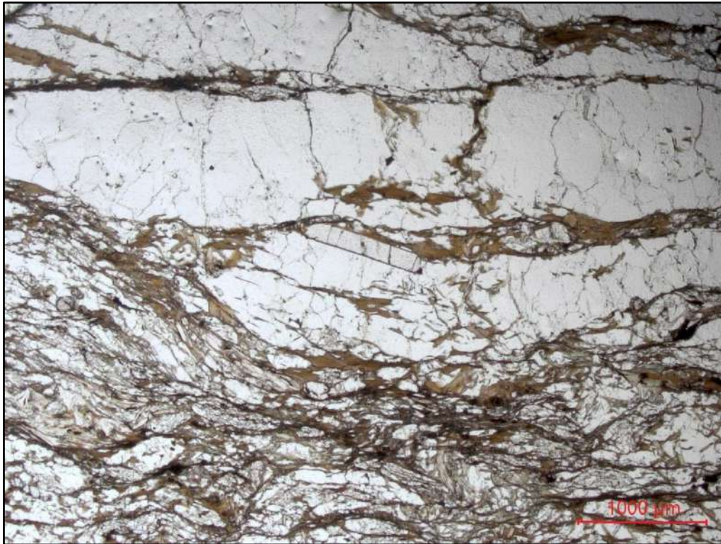
Figura 30. Cianita paralela à S2 em biotita xisto sugerindo seu crescimento sin-D2. Fotomicrografia em polarizadores paralelos. “ITM-BX02”.
