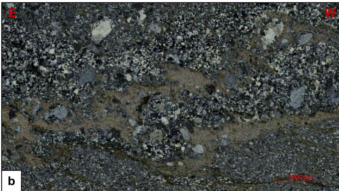
Figura 12. a) Foliação anastomosada, veios de quartzo (Q), lentes micáceas (M) e granada (G), orientada de NE – SW; e b) feldspatos de diversos tamanhos, quartzo recristalizado e lâminas irregulares ricas em micas e clorita, orientada de E-W. Biotita xisto em fotomicrografias com polarizadores a) paralelos e b) cruzados, de lâminas escaneadas com o programa Zen Blue.
