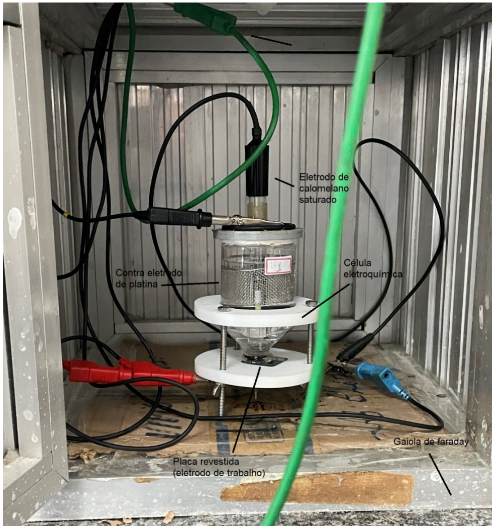
Figura 11 — Sistema eletroquímico com três eletrodos conectados a um potenciostato com analisador de resposta de frequência para ensaios de impedância e polarização. Em vermelho, o eletrodo de trabalho, em preto, o contra eletrodo e, em azul, o eletrodo de referência.
