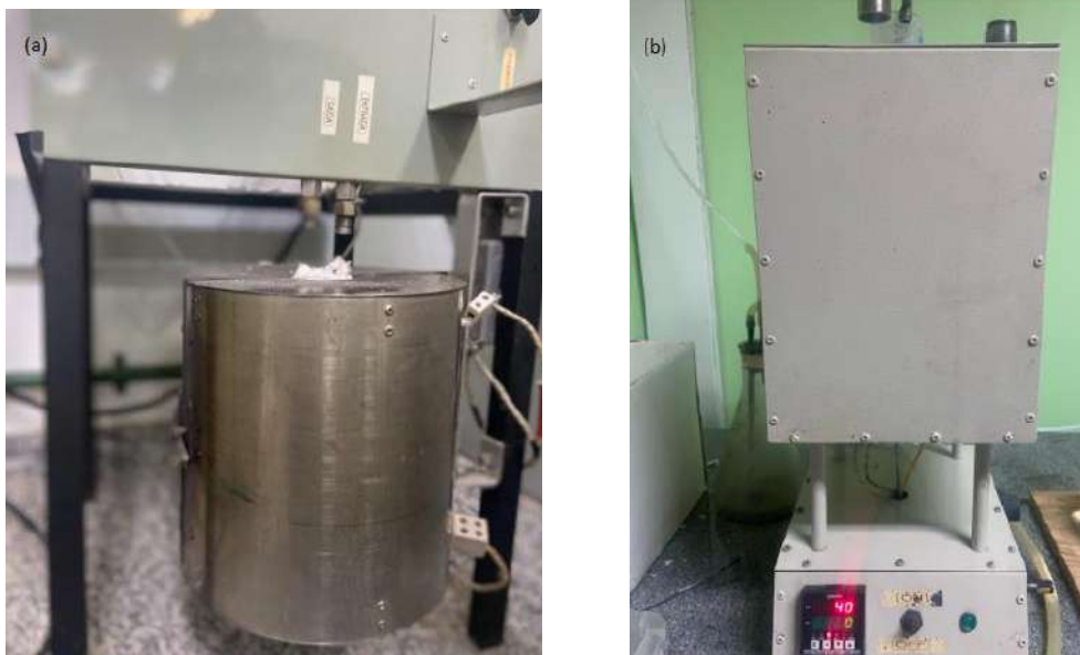
Figura 13. (a) Unidade de tratamento térmico com atmosfera de \text{H}_2/\text{N}_2 ; (b) Unidade de calcinação via ar
