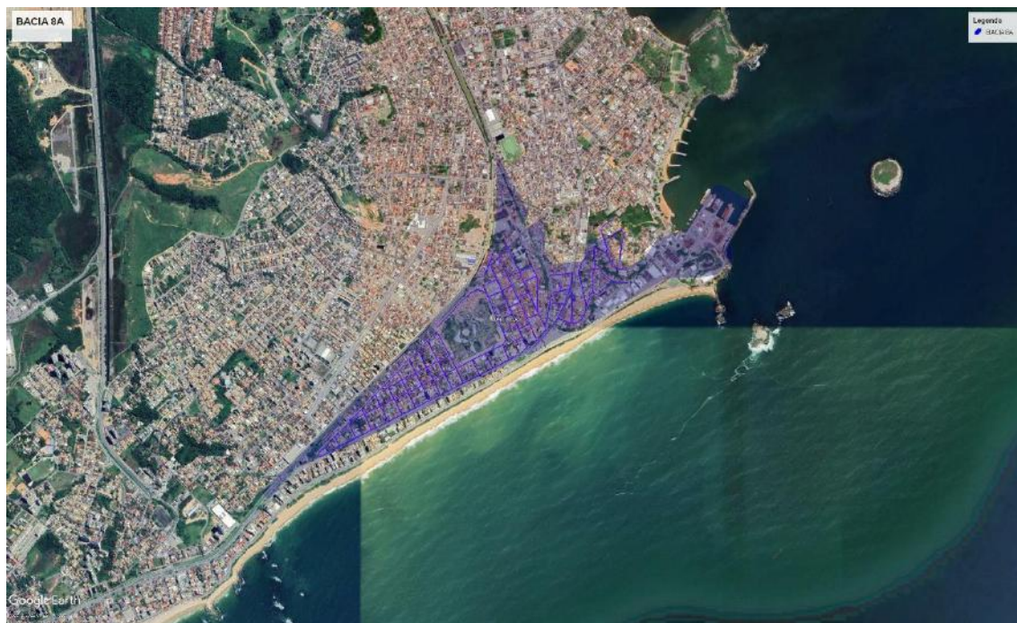
Figura 19: Bacia 8A com a marcação de sua extensão de rede. (Fonte: Autor/Google Earth, 2022).
