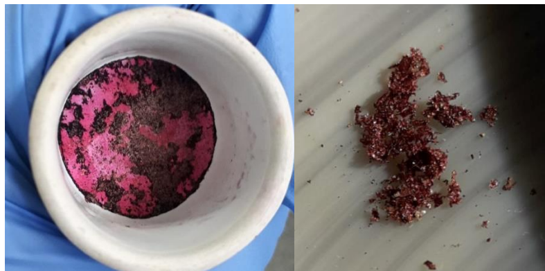
Figura 8: Material resultante da síntese de GN23 (RIO-75). À esquerda o material pós filtração do meio reacional e à direita o material seco.
