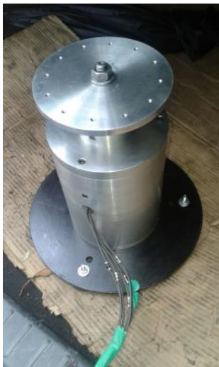
(a) Mancal Magnético com rotor.
