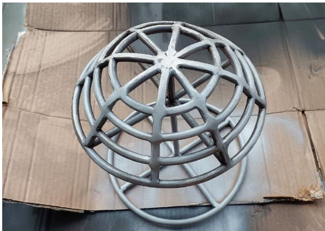
Figura 148 - Preparação com primer
