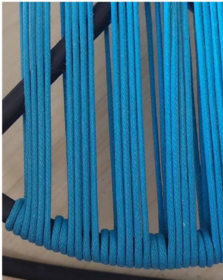
Figura 144 - Faixas espaçadas (Duas voltas ao redor do tubo para quatro linhas esticadas)
