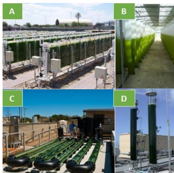
Figura 3 – Exemplos de cultivo de microalgas em sistemas fechados. (A) Painéis de placas planas de acrílico na Universidade Estadual do Arizona (EUA). (B) Sacos plásticos transparentes na Alemanha. (C) Tubos horizontais na Austrália. (D) Tubos verticais na Holanda.
