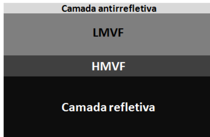
Figura 4.1: Diagrama esquemático da estrutura dos filmes. Nos filmes depositados em vidro, uma camada de titânio foi depositada como camada refletiva; nos filmes depositados em substratos metálicos, a própria superfície do substrato atua como camada refletiva. (retirado de ALENCASTRO (2014))
