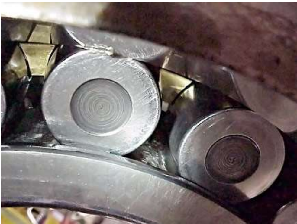
Figura 47 - Mancal danificado (SKF, 2018)
