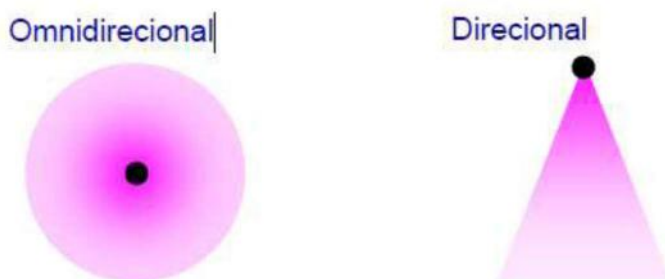
Figura 16 - Sinais de Antena Direcional e Omnidirecional
