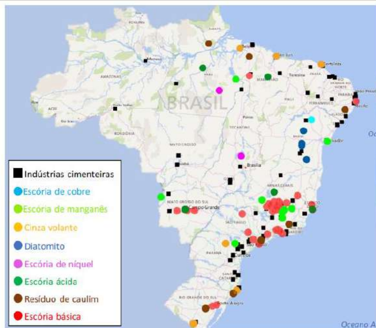
Figura III.7 - Distribuição geográfica dos polos geradores de alguns materiais cimentícios suplementares no Brasil. Fonte: Abrão, 2019
