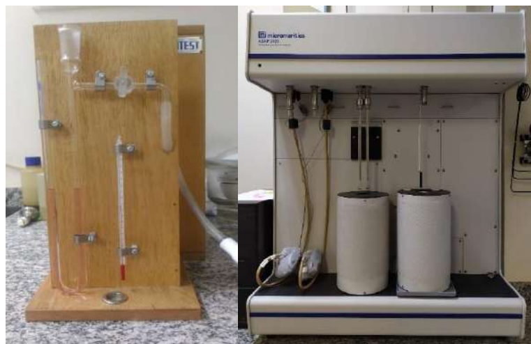
Figura IV.4 - Analisadores de área superficial. (a) Finura Blaine. (b) ASAP 2020 da Micromeritics.
