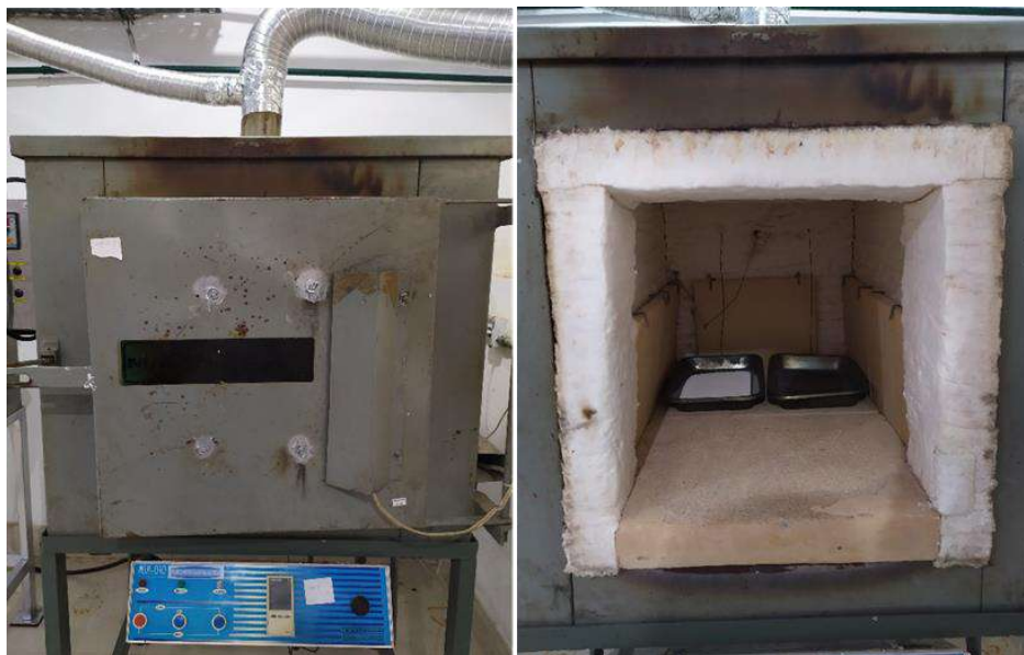
Figura IV.14 Mufla MS Mistura. (a) Fechada. (b) Disposição das bandejas e termopares.
