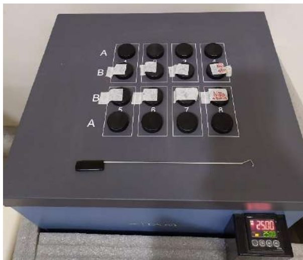
Figura IV.19 - Calorímetro de condução isotérmico TAM Air de 8 canais da TA Instruments.
