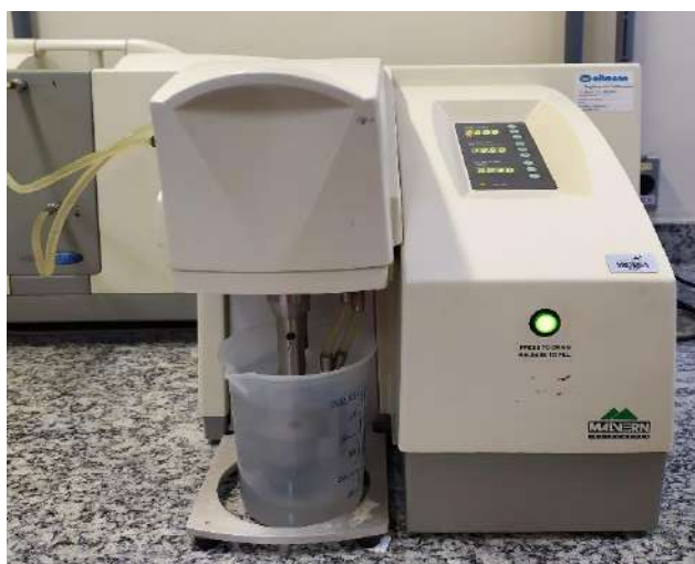
Figura IV.2 – Granulômetro a laser Mastersizer 2000 da Malvern.
