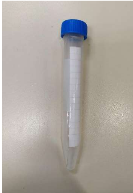
Figura IV.16 – Tubo Falcon graduado com papel milimetrado.
