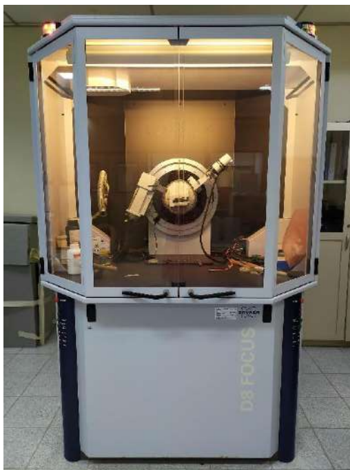
Figura IV.5 – Difratorômetro de raio X D8 Focus da Bruker.
