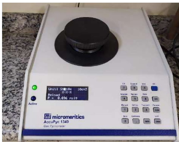
Figura IV.1 - Picnômetro a gás AccuPyc 1340 da Micromeritics
