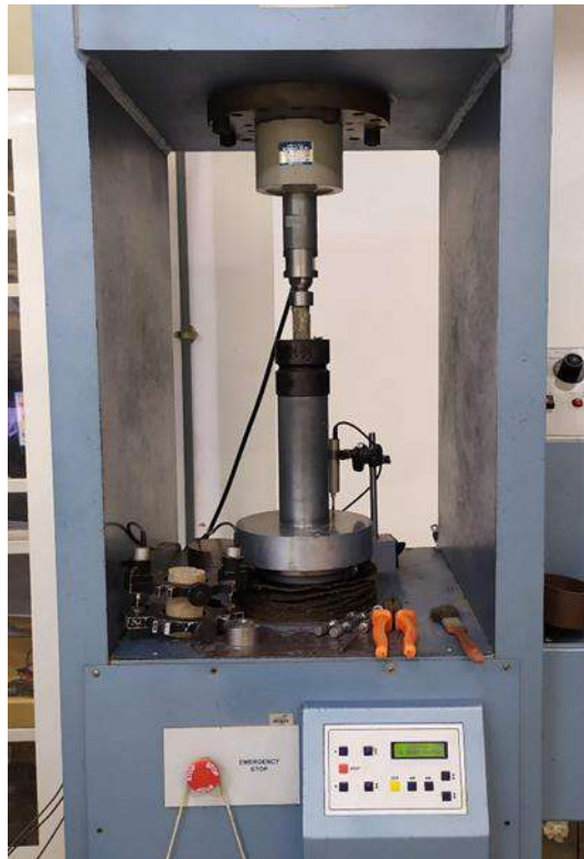
Figura IV.20 – Prensa Wikeham Farrance com célula de carga de 200 kN.
