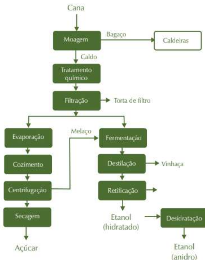
Figura 31 - Fluxo da produção de açúcar e bioetanol de cana
