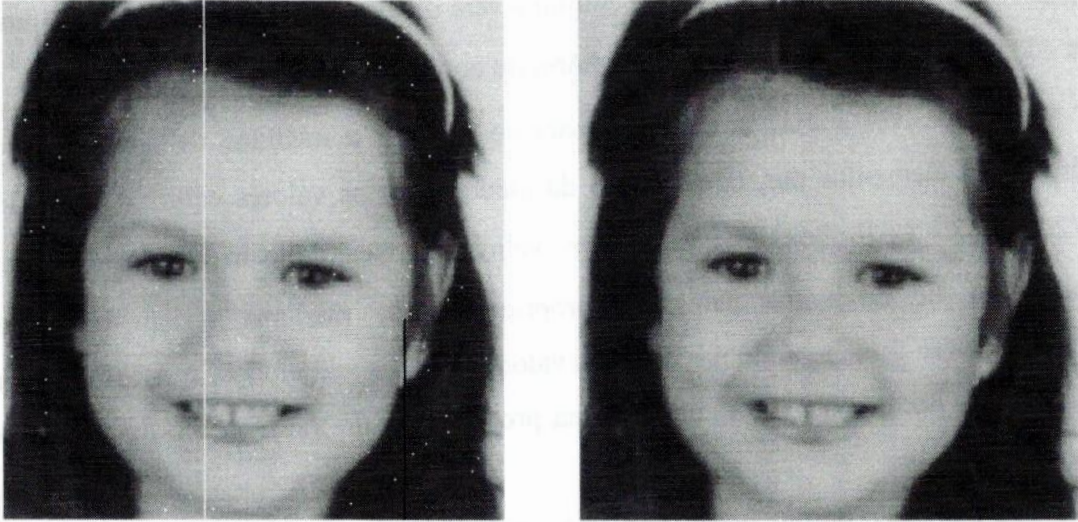
Figura 1.13: À esquerda, imagem com alguns defeitos em píxeis e colunas (introduzidos artificialmente). A mesma imagem processada com um filtro mediano com largura de 3 píxeis pode ser vista à direita.
