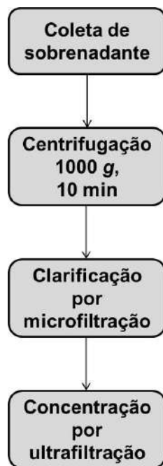
Figura 3.1: Arranjo experimental incluindo as etapas de clarificação e concentração de sobrenadante de cultivo celular contendo as partículas pseudovirais.
