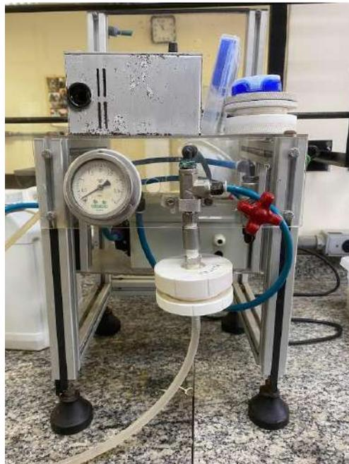
Figura 15. Equipamento para aferição do índice de incrustação. Fonte: Autor.
